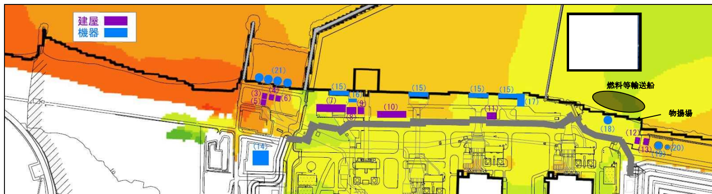
図 4.2-12-3 漂流物調査結果 (発電所構内荒浜側護岸部詳細)
