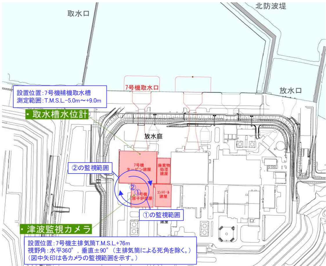
図 5.2-4 津波監視設備の配置図
