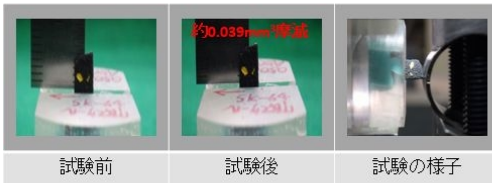
図4 スラッジ摩滅の様子および試験の様子（ケース1の例）
