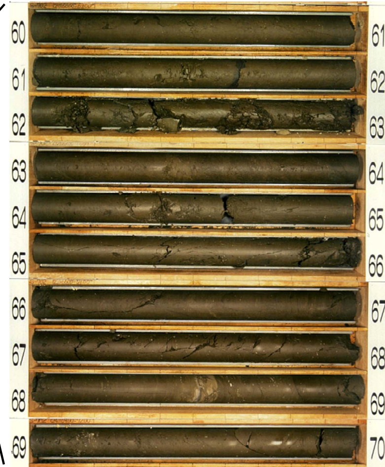
S-702孔 コア写真(深度60m~70m)
