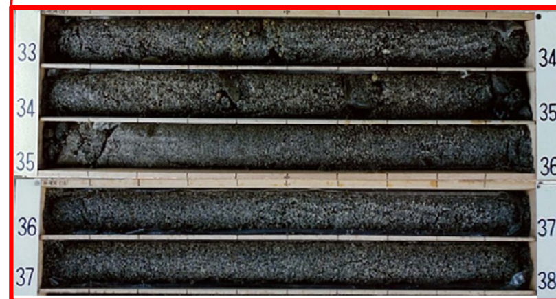
dF-a断層想定延長部の拡大コア写真
