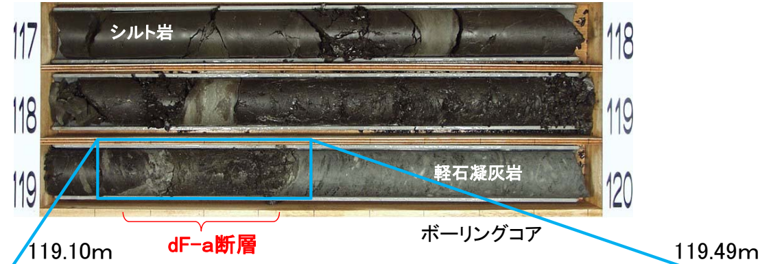
【P-1孔】 深度119.44m 断層面の傾斜約45°
