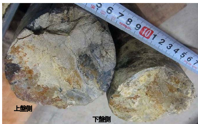
深度174.25m直上の割れ目面に条線等は認められない。
