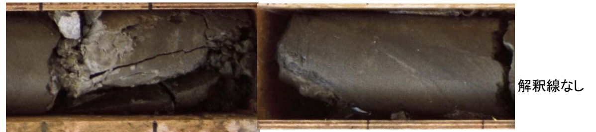
礫状の破碎部 破碎幅:約6cm
