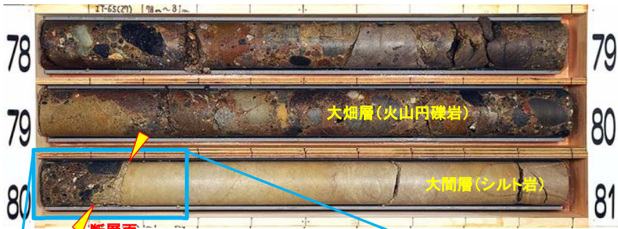
断層面 (粘土状破砕部) 写真1 ボーリングコア(78m~81m)
