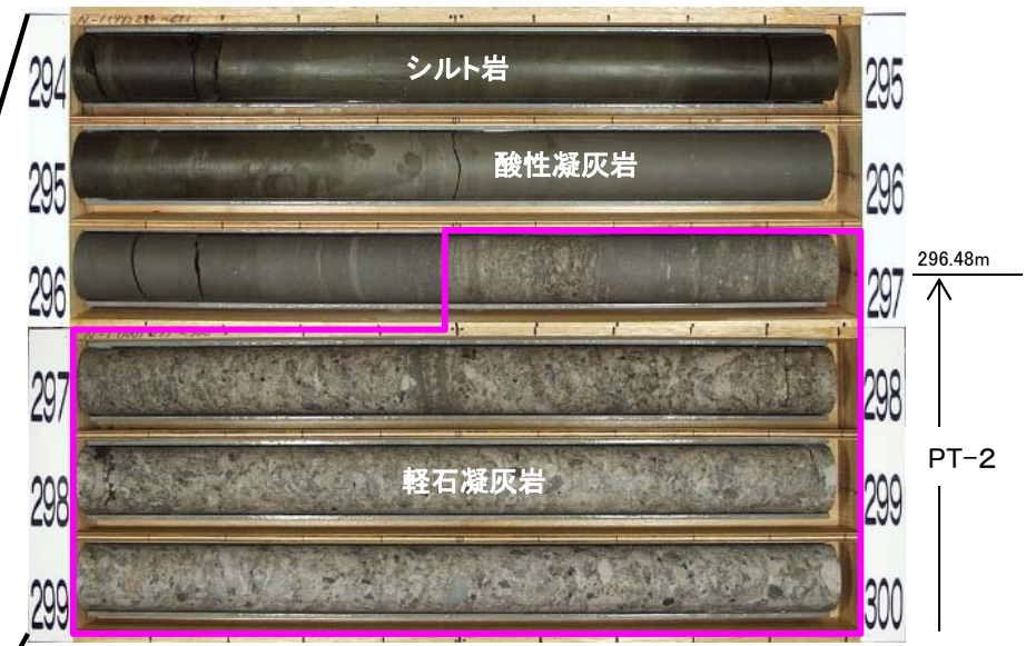
N-1孔 コア写真(深度294m~300m)
