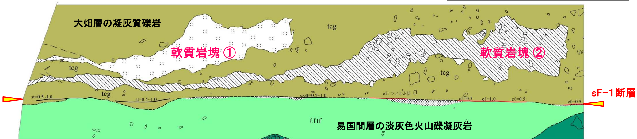
掘削面底盤Aの地質スケッチ
