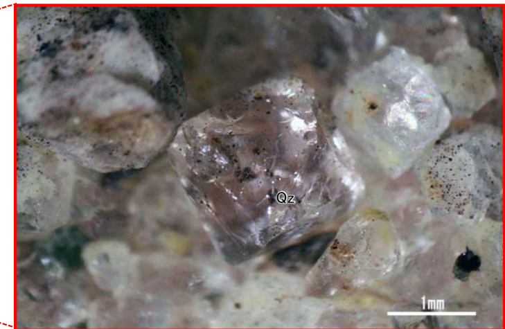
写真1-3 同左実体鏡拡大写真 粒径2mm程度の大きな石英粒子(いわゆる算盤玉状の結晶形を呈する)が認められる。
