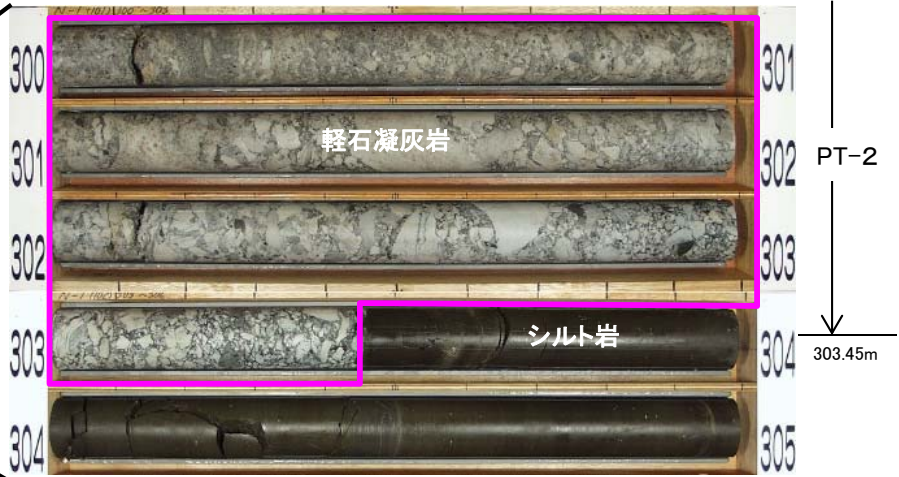
N-1孔 コア写真(深度300m~305m)
