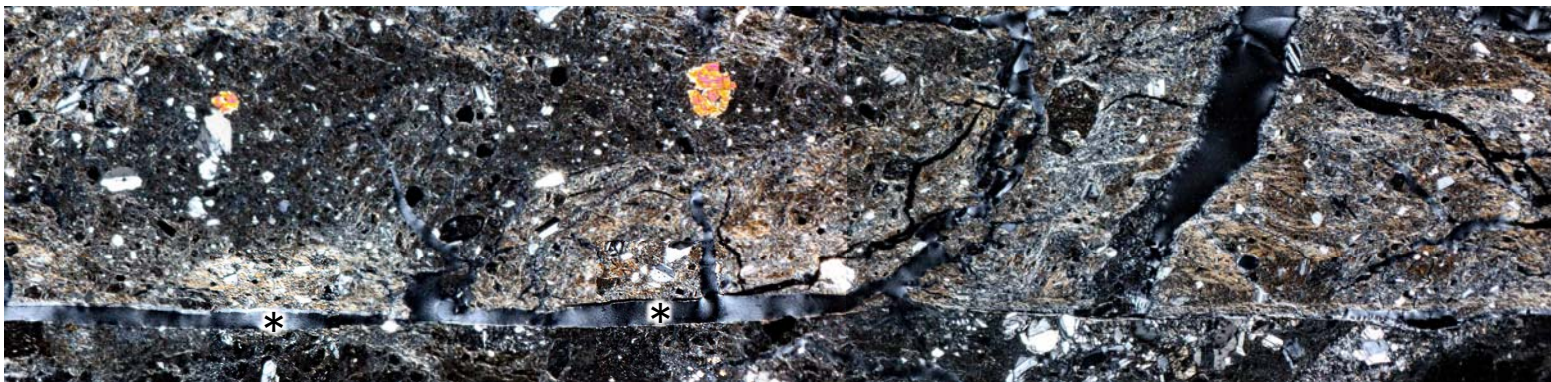
回転写真 薄片(クロスニコル) 時計回りにステージを 60° 回転
