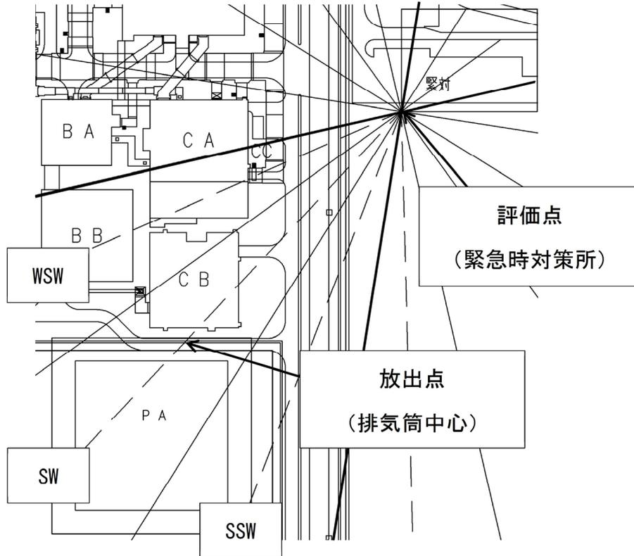
添3-イ第14図 緊急時対策所の居住性に係る被ばく評価における着目方位
