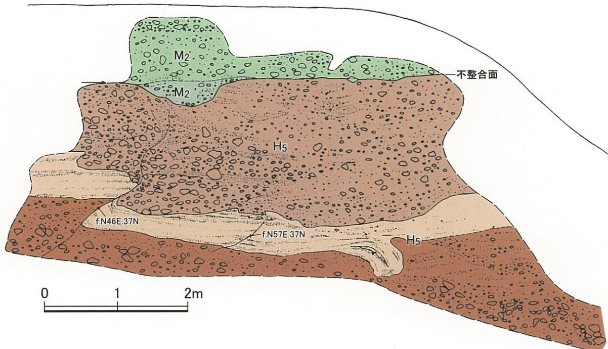
高位段丘堆積層 (H5面堆積物) に変位を与える逆断層である。
