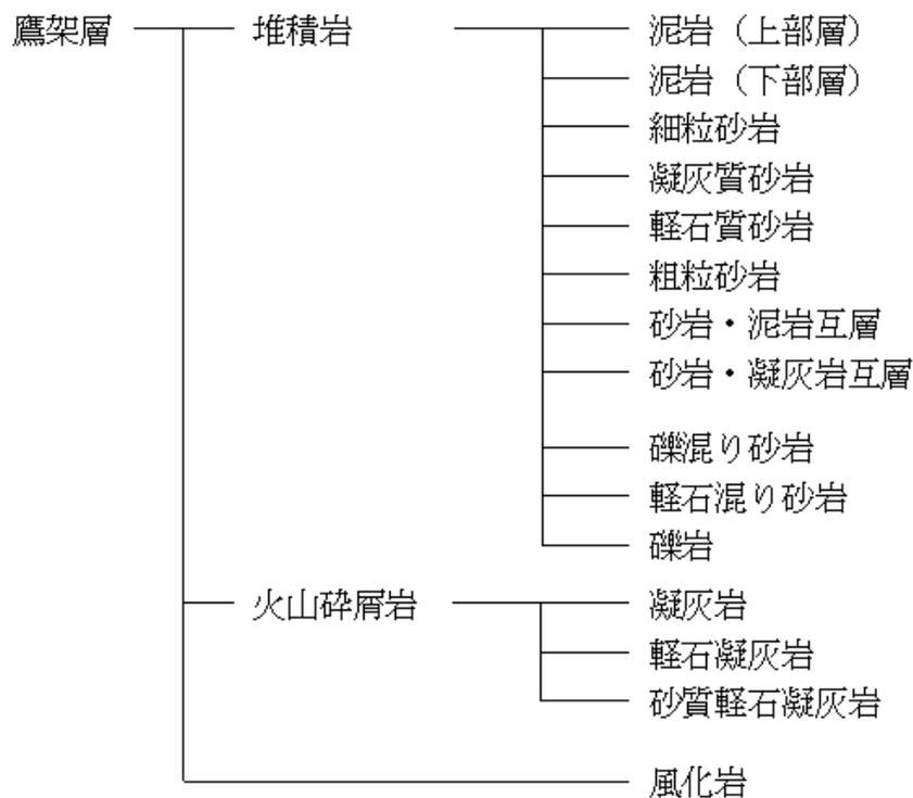
上記の岩盤分類にPP1，PP2，PH，断層（f系断層），造成盛土，埋戻し土，流動化処理土及びマンメイドロック（以下，「MMR」という。）を含めた解析用地盤分類を用いて，岩盤分類図を添3-ロ(ホ)第6図に示す。
