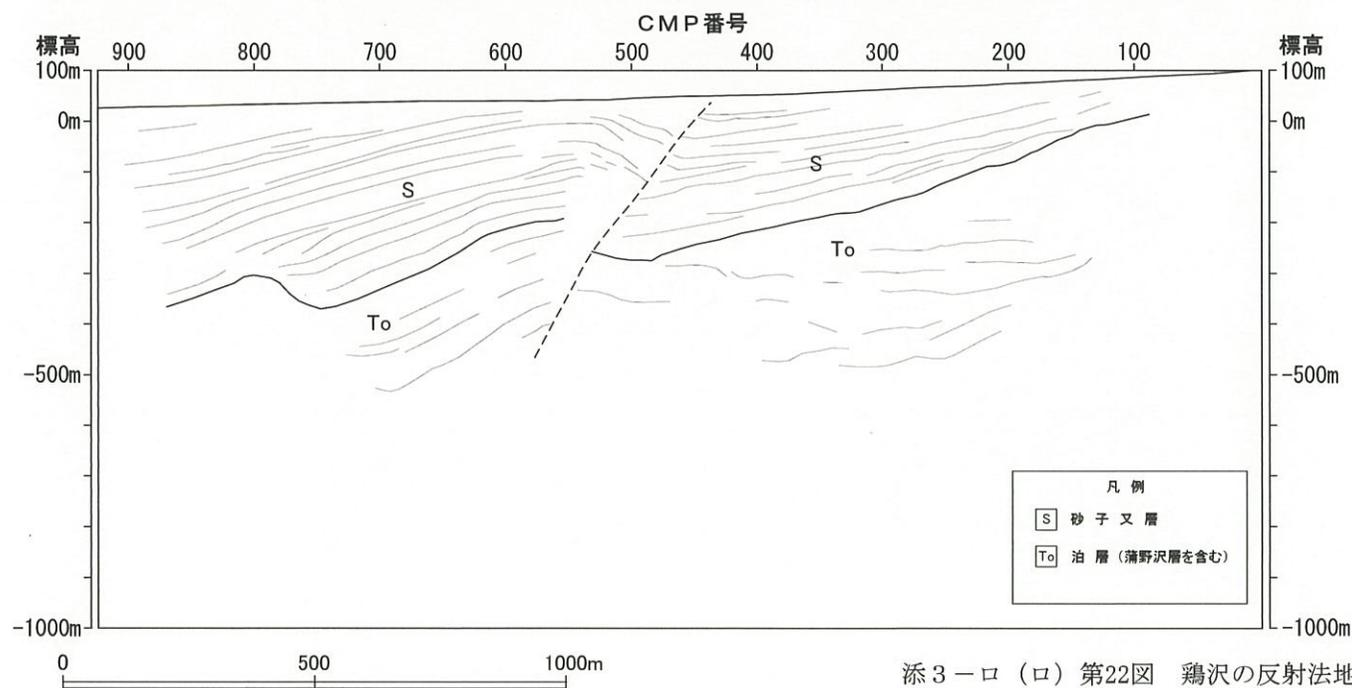
添3-ロ(口)第22図 鶏沢の反射法地震探査結果図(深度断面)
