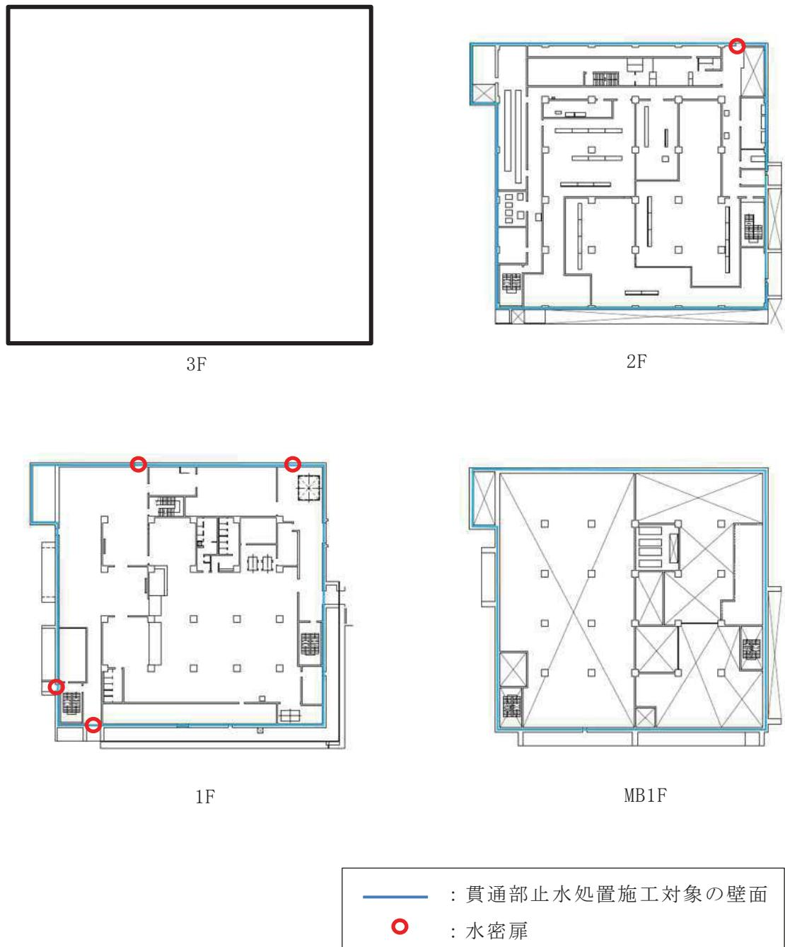
図 3-35 貫通部止水処置及び水密扉の位置図 (4/5)
