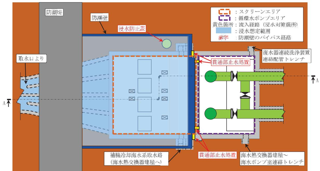
図 2-4 (6) 第 3 号機 海水ポンプ室 浸水対策配置図 (平面図)
