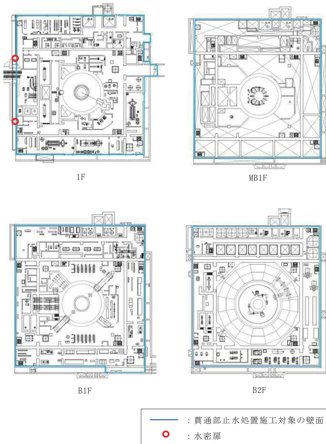
図 3-35 貫通部止水処置及び水密扉の位置図 (2/5)
