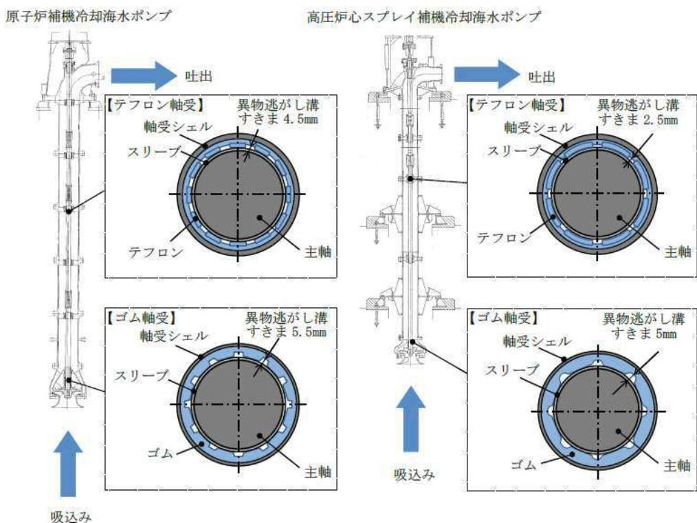
図 3-40 非常用海水ポンプの軸受構造図
