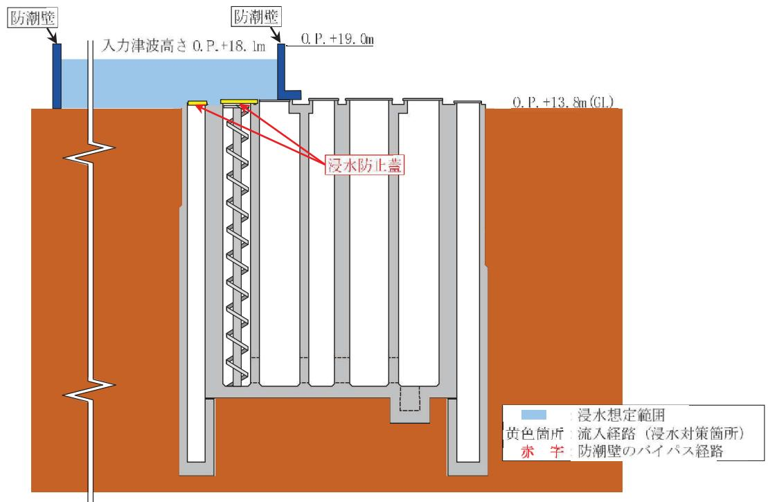
図 2-4 (3) 第 2 号機 海水ポンプ室 浸水対策配置図 (B-B 断面図)
