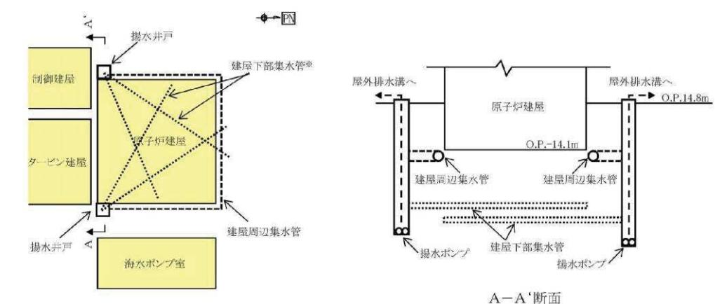
図3-33 地下水位低下設備の概要図（原子炉建屋の例）
