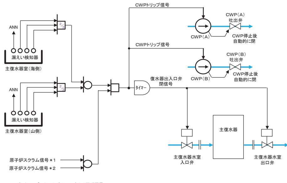
図 3-30 循環水系配管溢水対策インターロックの概要
