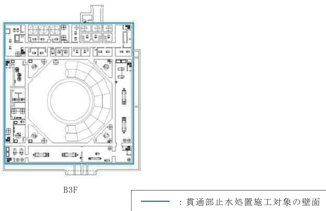
図 3-35 貫通部止水処置及び水密扉の位置図 (3/5)
