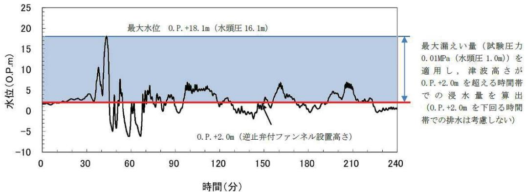
図 3-28 逆止弁付ファンネルからの浸水量評価適用図
