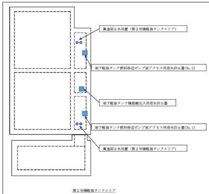
図 3-34 浸水防止設備（内郭防護）の位置の概要図（2／2）
