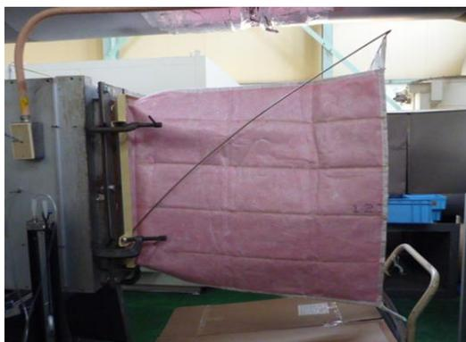
図1 バグフィルタの耐荷重試験の様子
