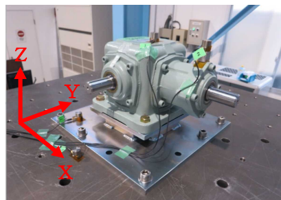
図 1-7 振動試験装置外観 (マイタギヤボックス (ED6M-1-L-Y))
