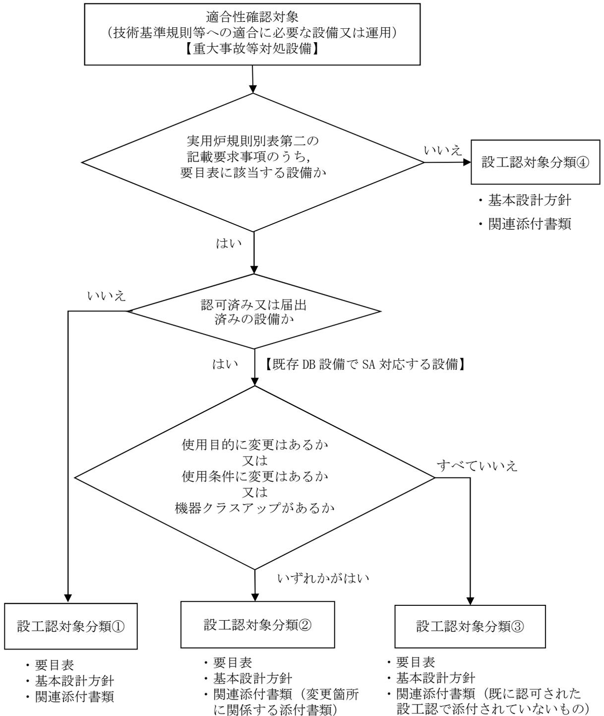
第7図 適合性確認対象設備の設工認に記載する箇所の選定 (重大事故等対処設備)
