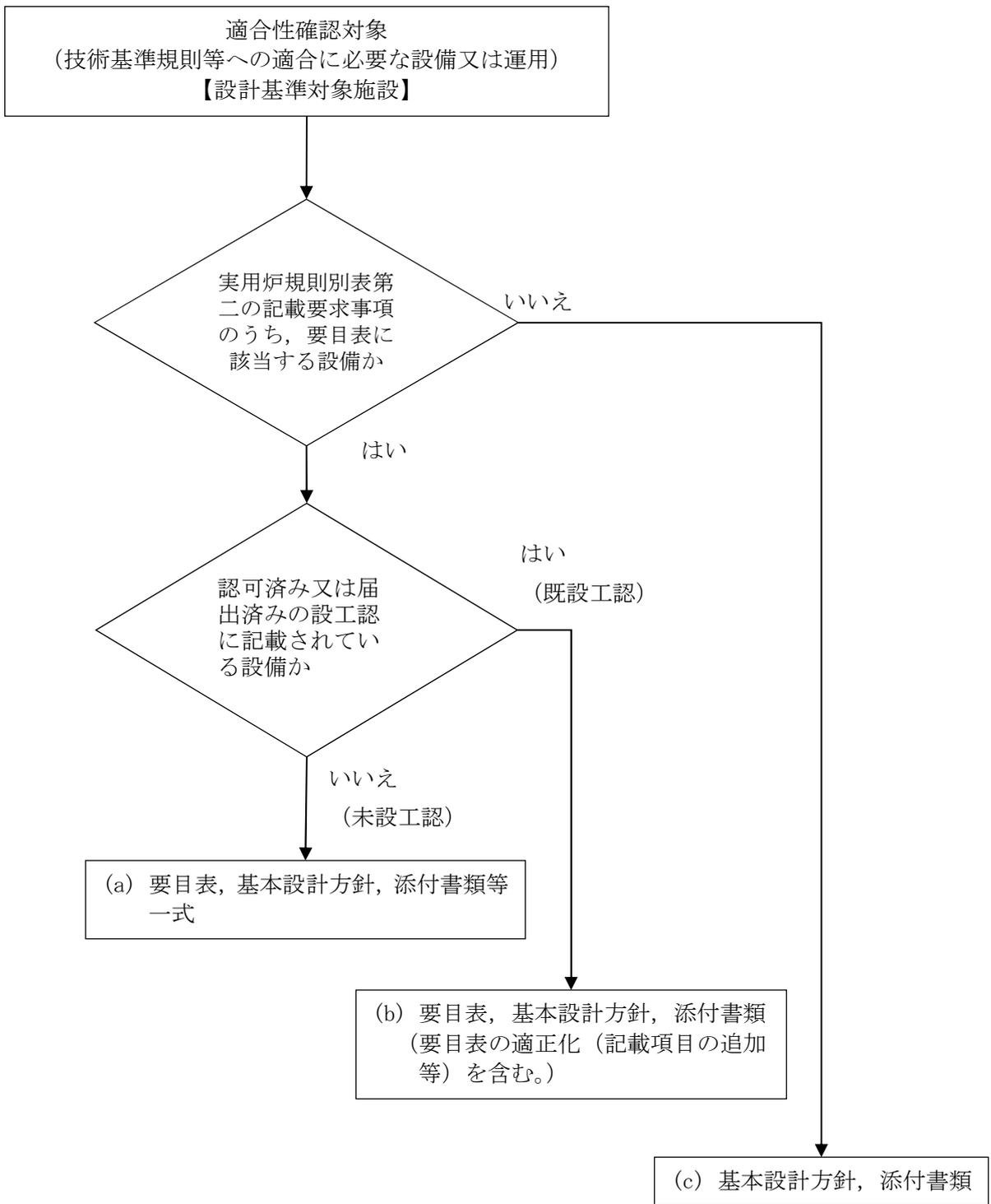
第6図 適合性確認対象設備の設工認に記載する箇所の選定 (設計基準対象施設)
