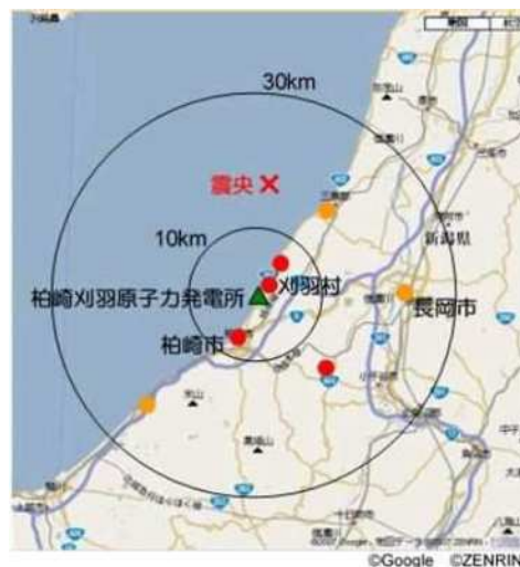
図3-1 シミュレーション解析に用いる地震の諸元（新潟県中越沖地震）
