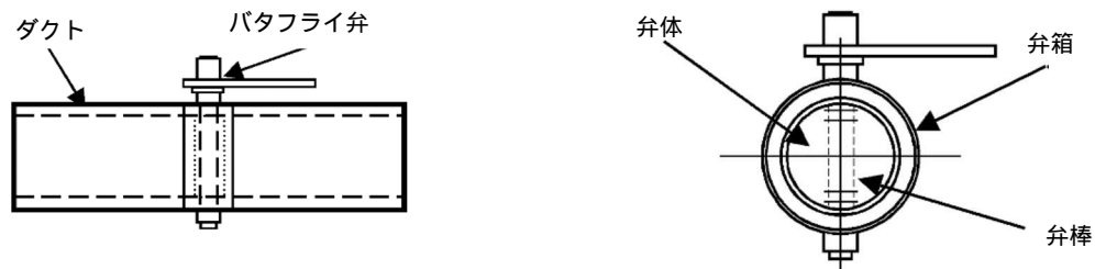
図2 - 5 バタフライ弁の概要図
