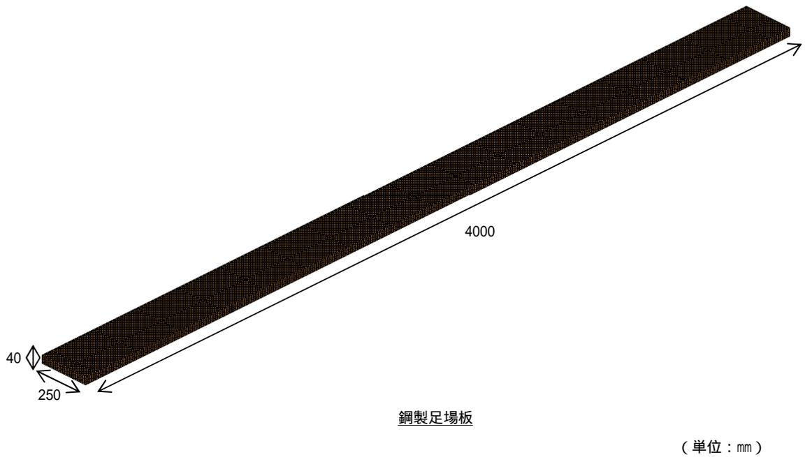
図3-6 設計飛来物の解析モデル図
