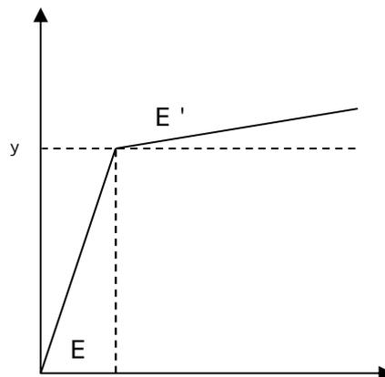
図 3-7 応力 - ひずみ関係の概念図
