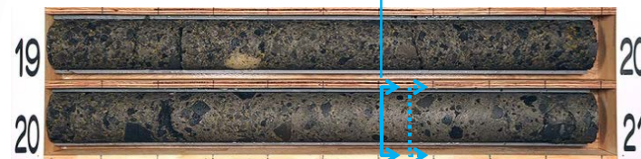
① ボーリングコア (CB-12孔 深度19m~21m)
