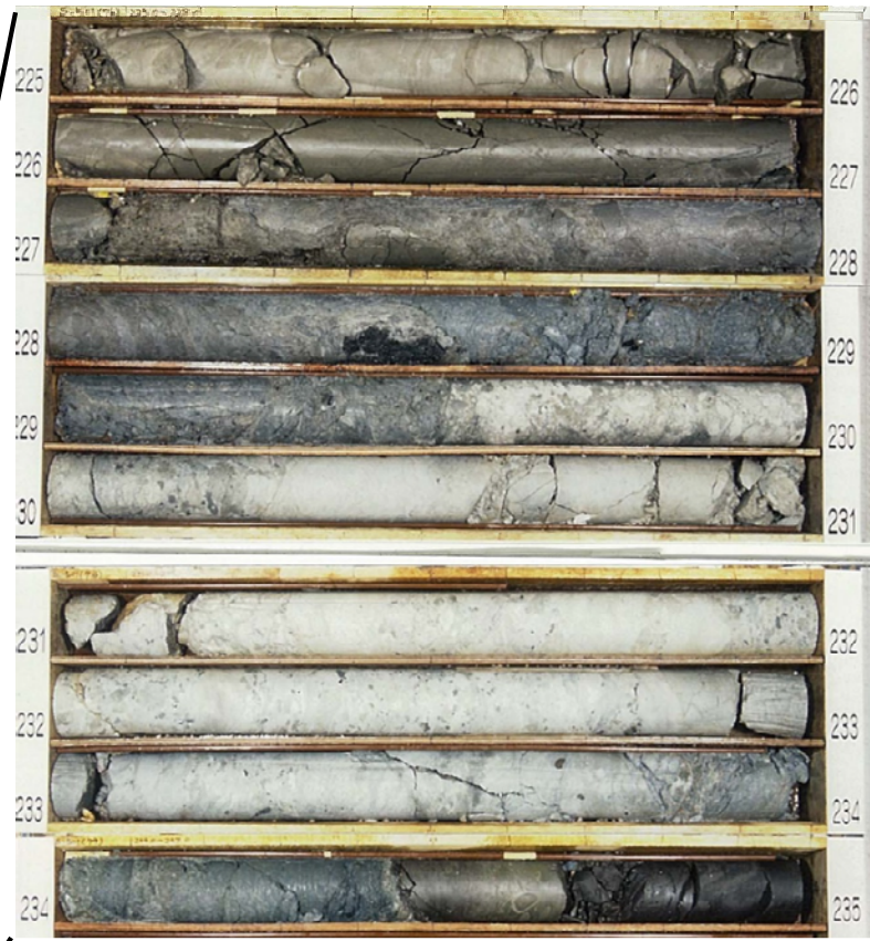
S-501孔 コア写真(深度225m~235m)
