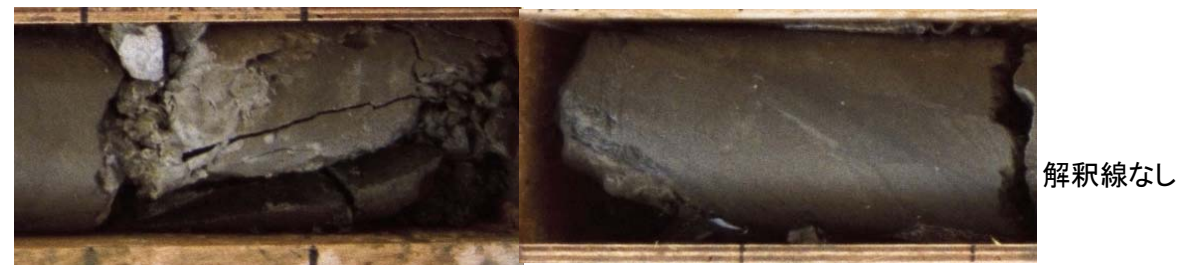
礫状の破碎部 破碎幅:約6cm
