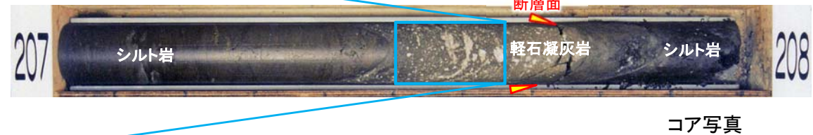
【S-601孔】 深度207.68m 海域のdF断層系の断層(dF-m1断層) 傾斜約65° ~約75°
