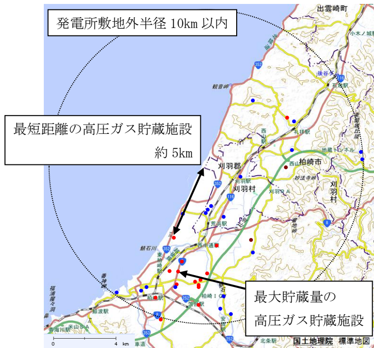
図 2-15 最短距離の高圧ガス貯蔵施設及び最大貯蔵量を保有する高圧ガス貯蔵施設の位置
