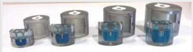
IRSNで開発された年齢別ファントムでも校正実施 ( 131 Iについては数学ファントムとほぼ同等の結果)
