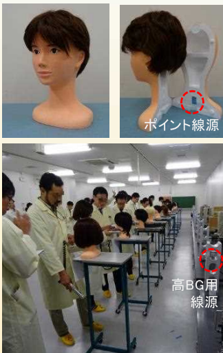
数MBq程度の密封線源を用いて高BG環境(~0.5μSv h -1 )を模擬
