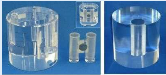
ORINSファントム Ref. ORINS-19 Thyroid radioiodine uptake measurement (1959) ANSIファントム Ref. ANSI N44.3-1973 Ref. ANSI/HPS N13.44-2014
