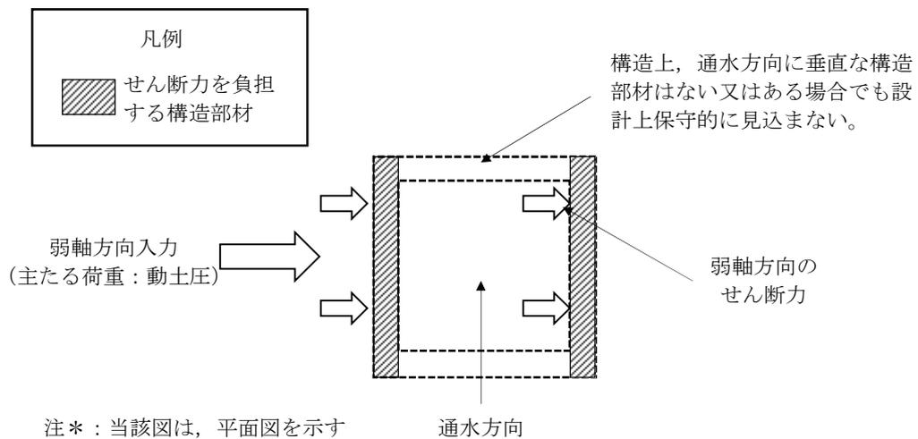
図 4-4 従来設計手法の考え方
