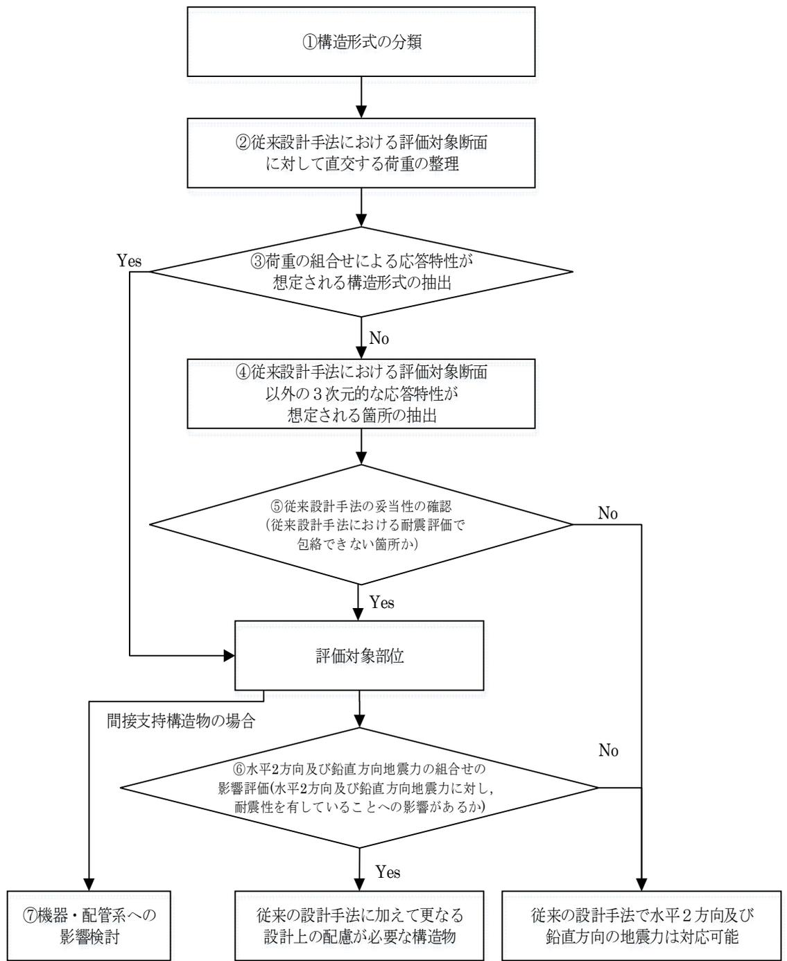
図 4-5 水平 2 方向及び鉛直方向地震力の組合せによる影響評価のフロー
