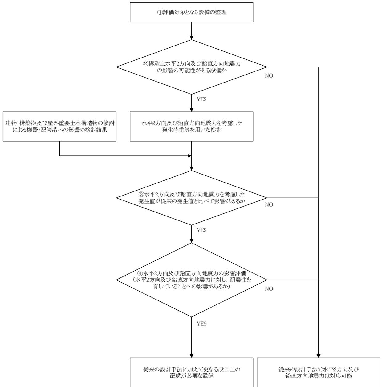
図 4-3 水平 2 方向及び鉛直方向地震力の組合せによる影響評価のフロー (機器・配管系)
