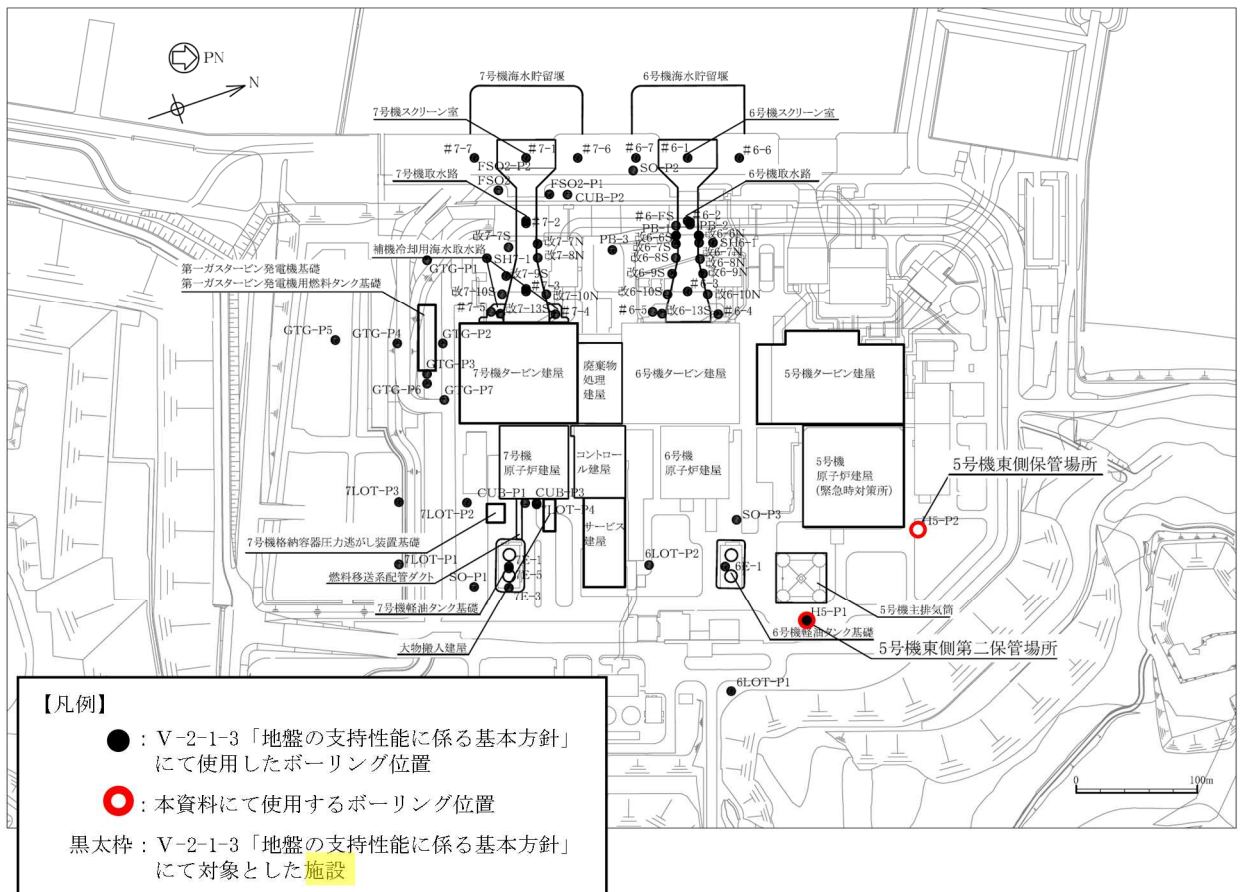
図1-1 5号機東側保管場所及び5号機東側第二保管場所とV-2-1-3「地盤の支持性能に係る基本方針」にて対象とした施設の位置関係
