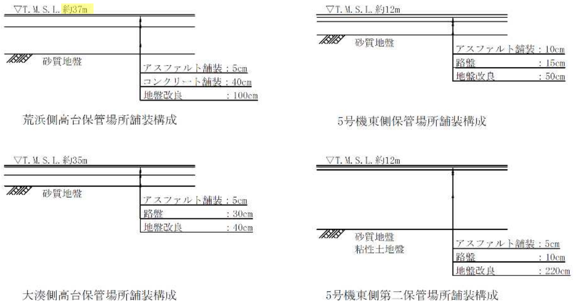
図 6-4 各保管場所の舗装構成
