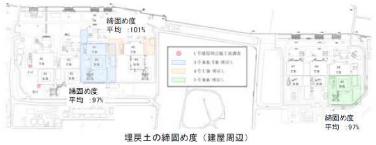
埋戻土の締固め度 (建屋周辺)
