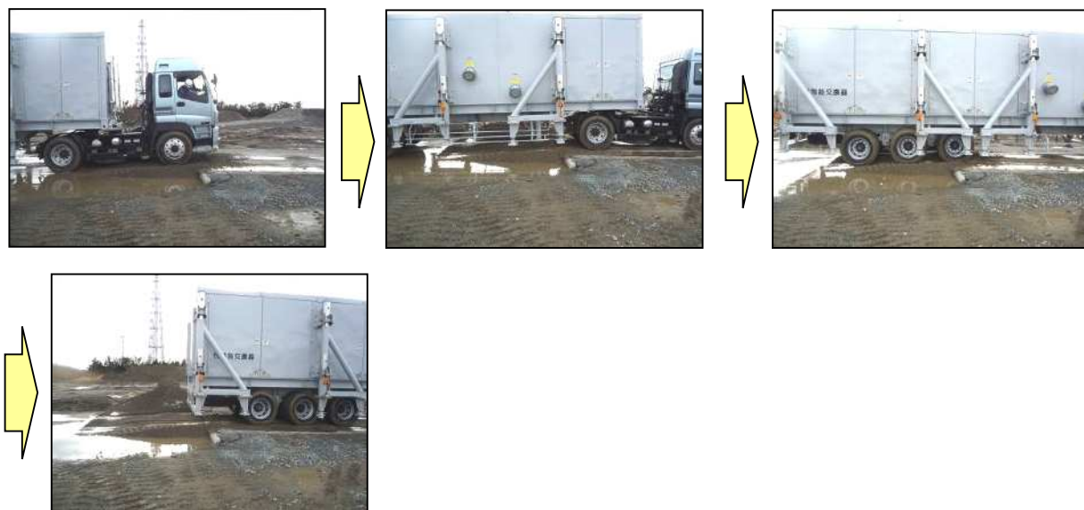
図 12-9 検証状況（約 20cm の段差）
