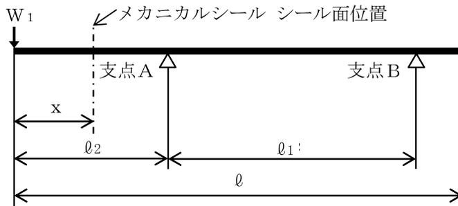
図 4-3 メカニカルシールの評価モデル
