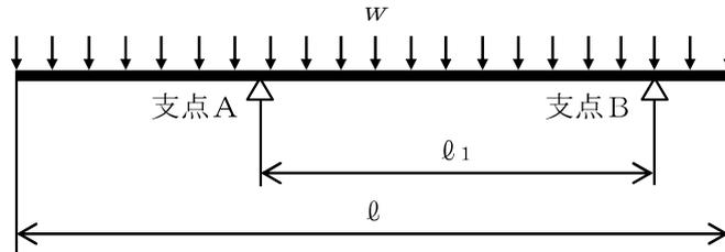
図 4-2 摺動部（主ねじ部）の評価モデル
