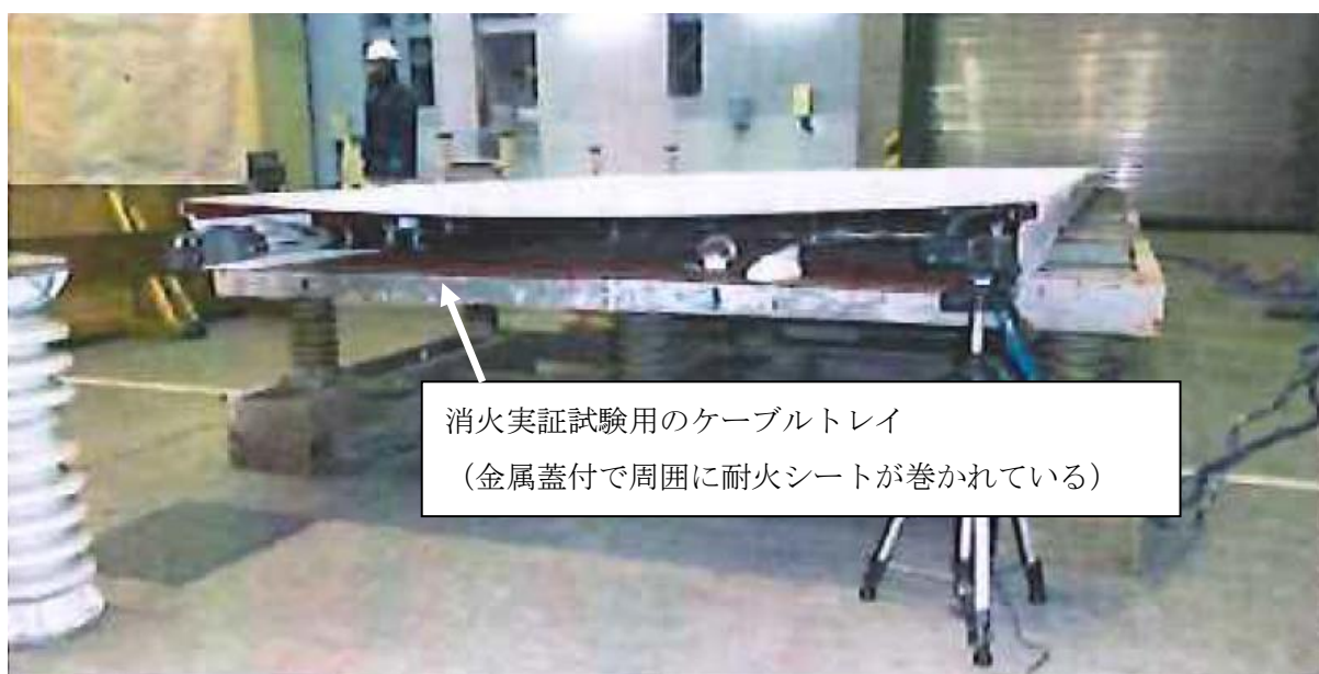
第5図 消火実証試験用のケーブルトレイ外観
