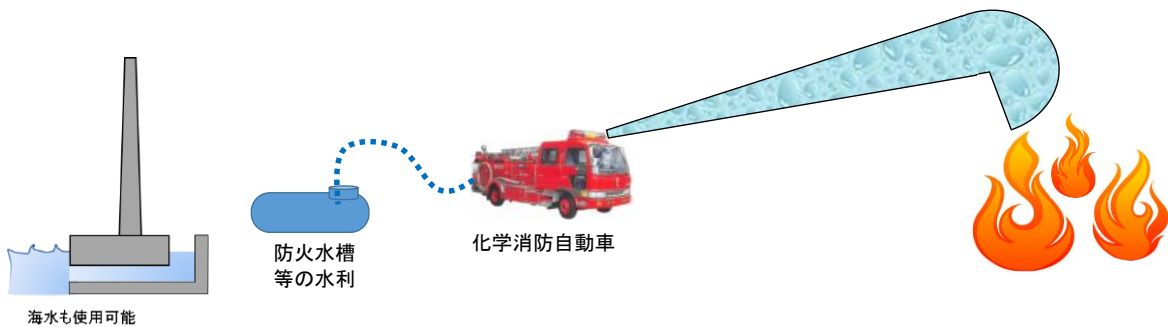
化学消防自動車による泡消火の例
