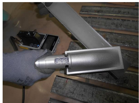
平板化した排水管を直接測定
