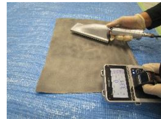
直接法による切断後の排気管の測定
