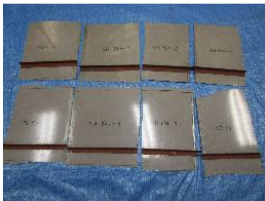
縦排気管分割平板化
