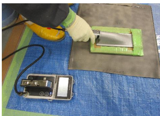
直接法による排気管の測定
