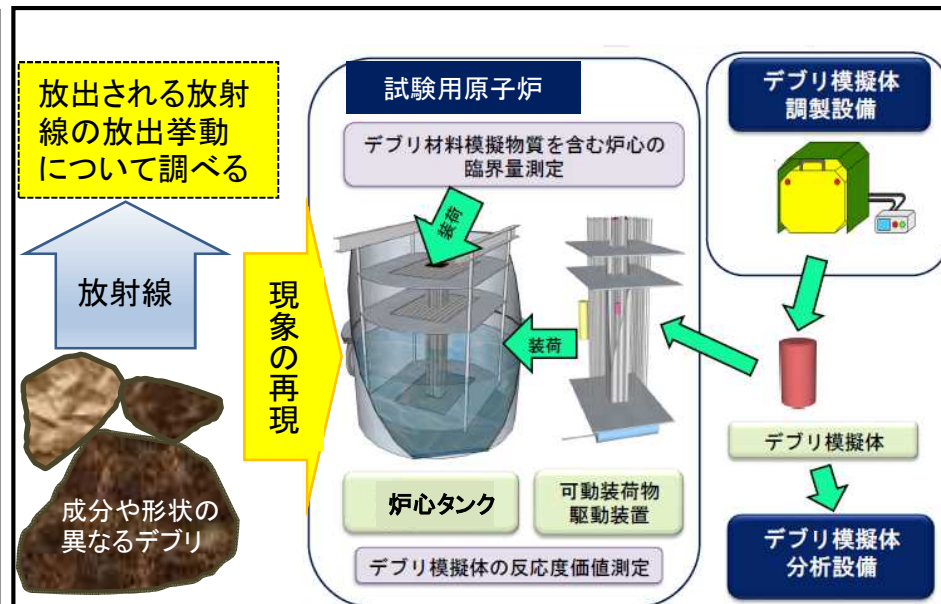
図1 試験用原子炉におけるデブリ模擬体を用いた実験の進め方例 (一部JAEAの公開資料より抜粋)
