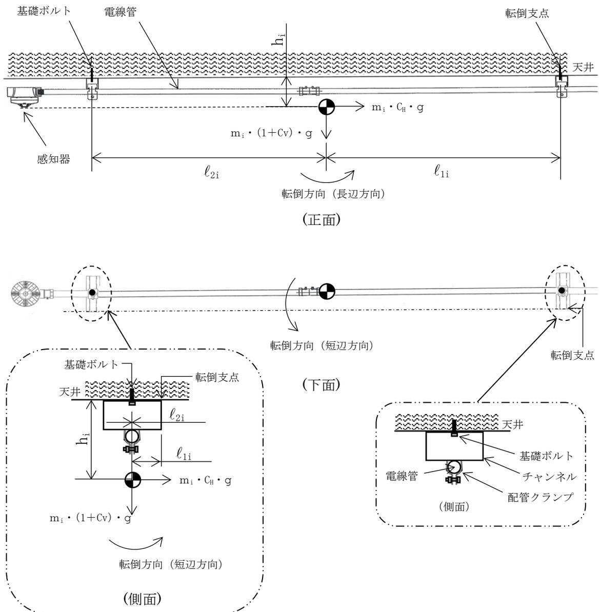
図5-1 熱感知器及び煙感知器 計算モデル
