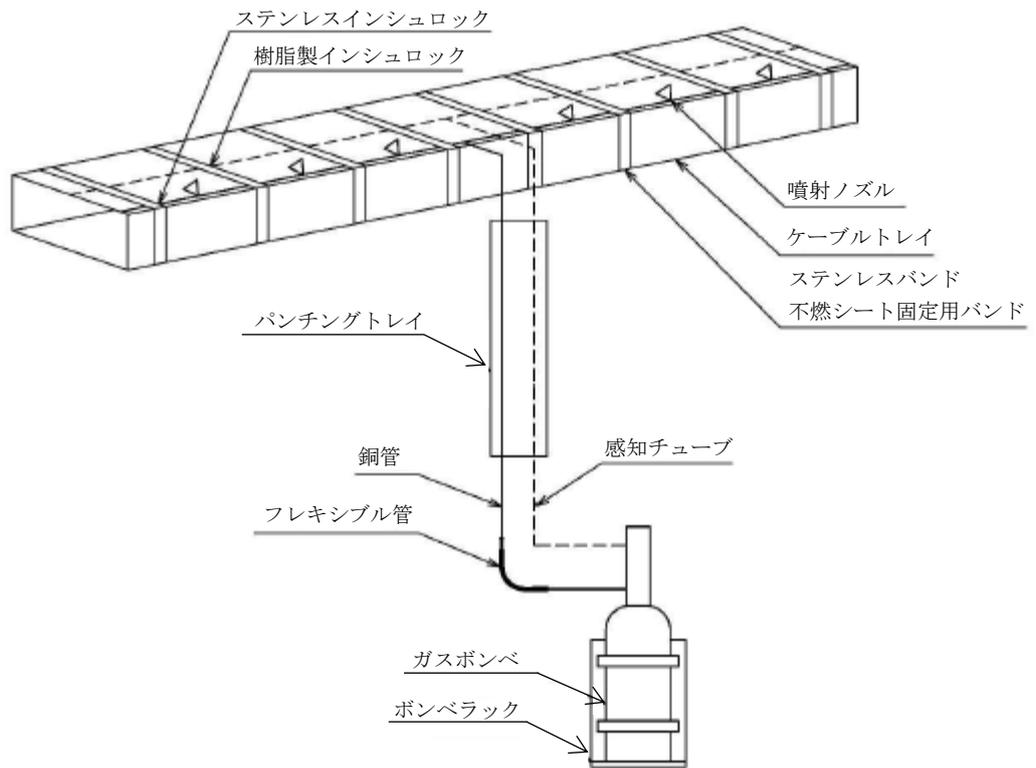
図 2-20 消火配管 (ケーブルトレイ消火設備) の概要図
