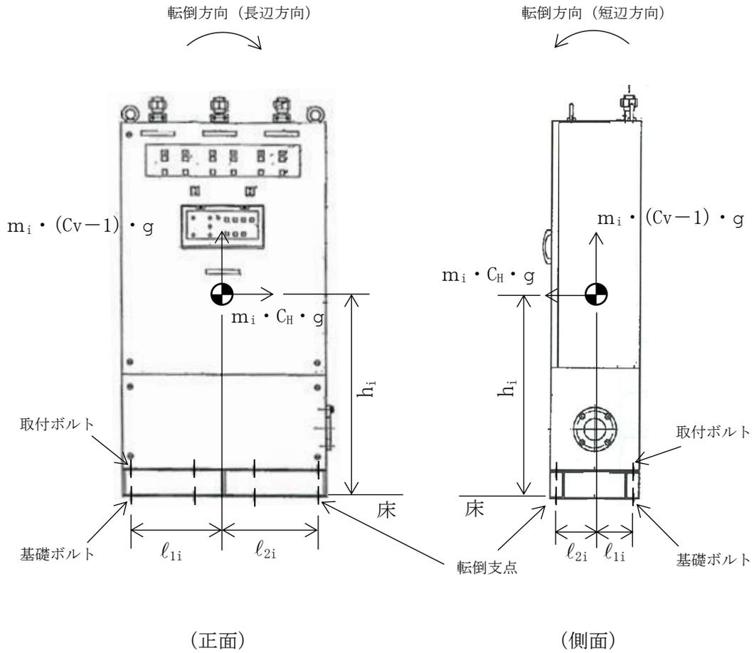
図5-3 煙吸引式検出設備 計算モデル
