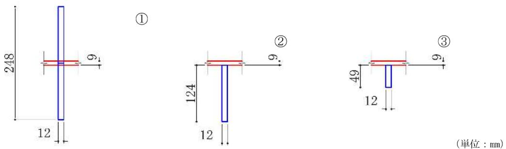
図 2.2-3-30 リブプレートの照査断面
