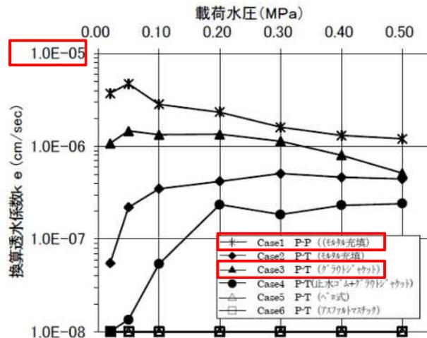
図- 11 継手遮水性能試験結果
