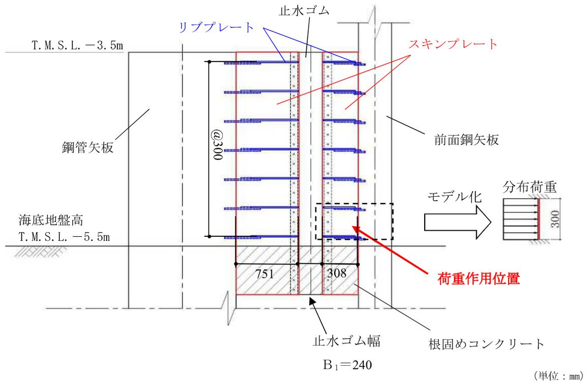
図6 スキンプレートの照査モデル (南側)
