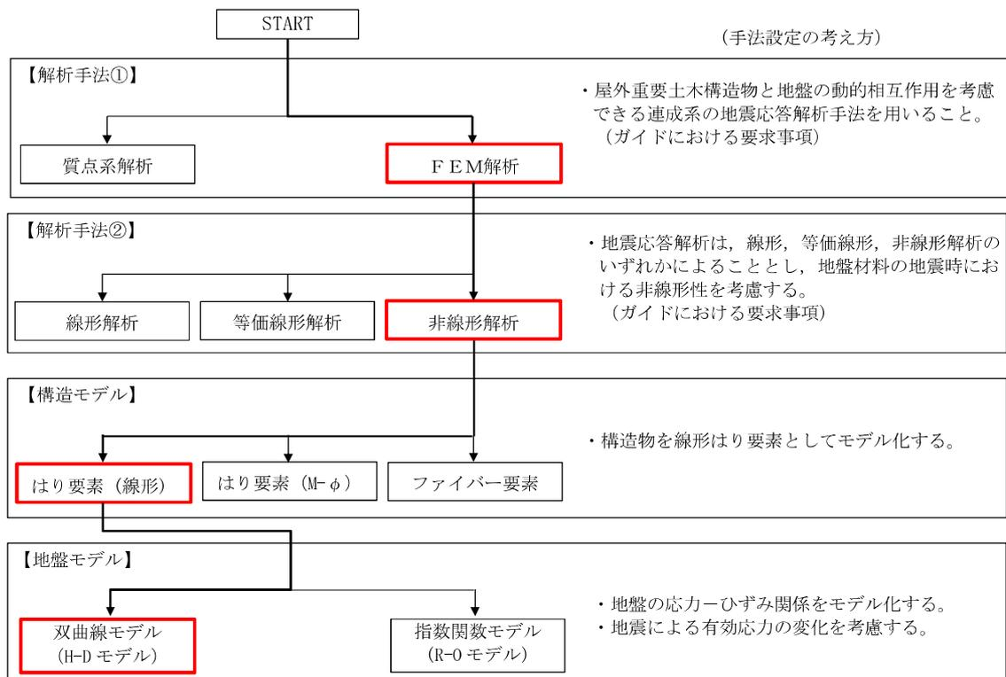
図 2.2-3-4 地震応答解析手法の選定フロー
