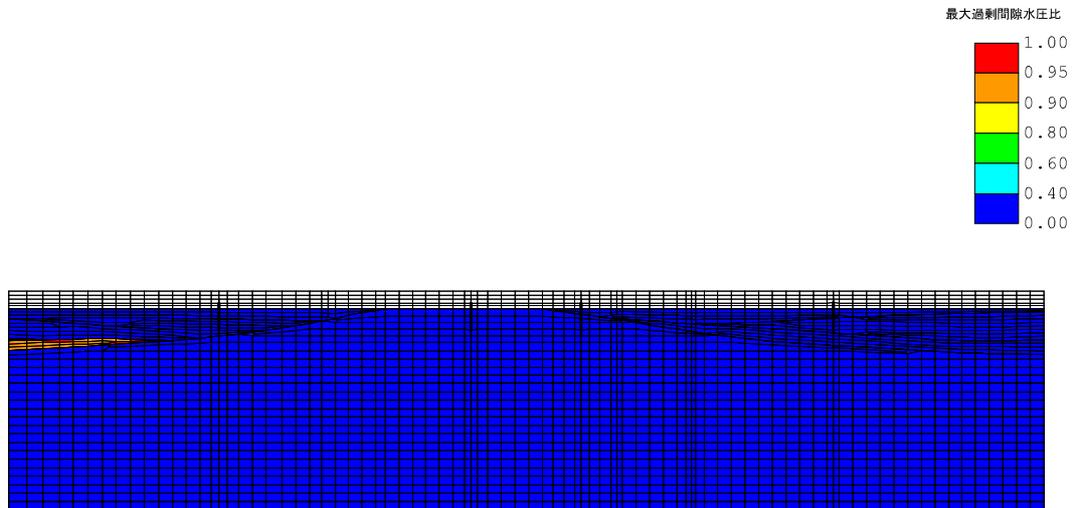
図 2.2-4-6 最大過剰間隙水圧比分布
