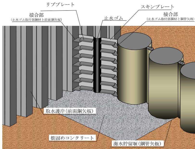
図 2 海水貯留堰南側接続部の鳥瞰図
