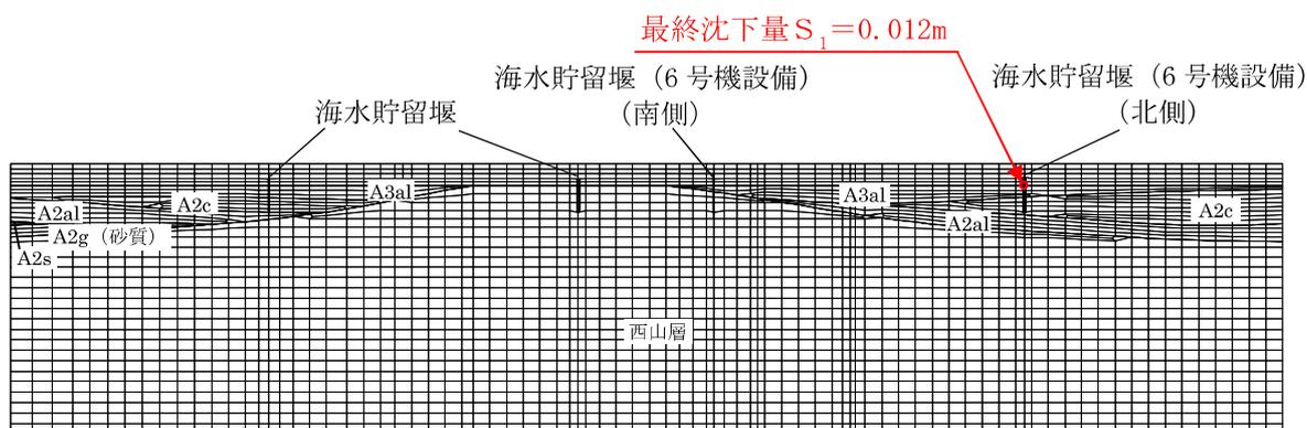
図10 地盤の変形による最終沈下量 $S_1$ の設定位置と値
