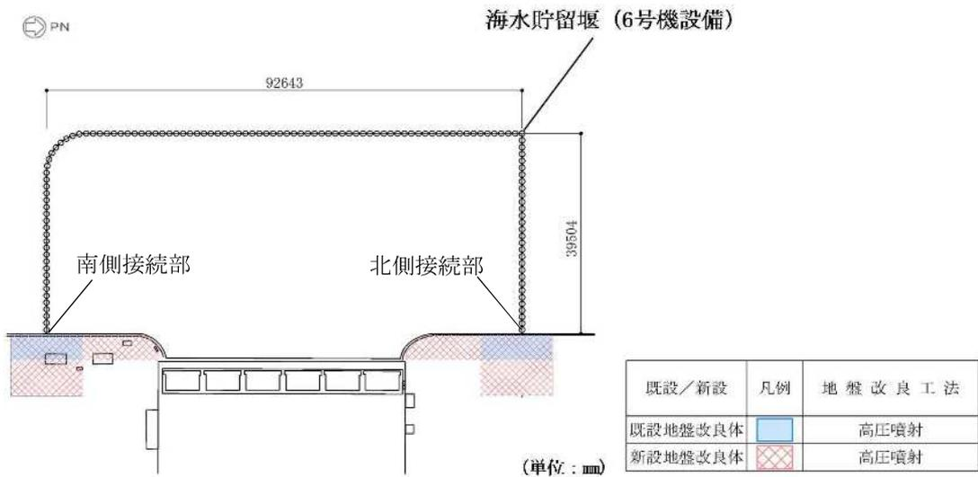
図 1 海水貯留堰の平面図
