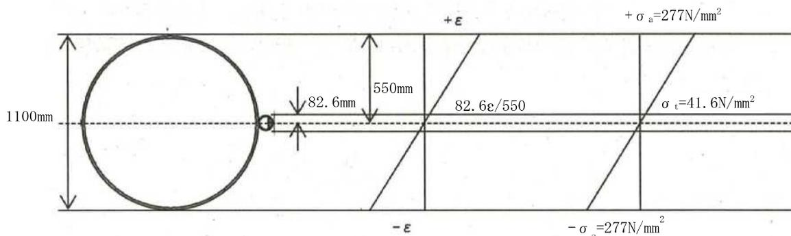
図4 鋼管及び継手鋼材の応力分布
