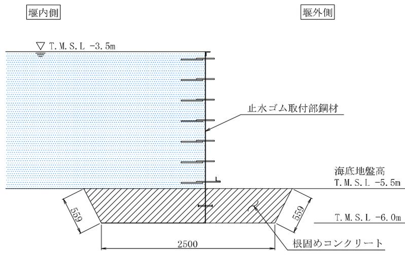
図 2 根固めコンクリートの形状 (断面図)
