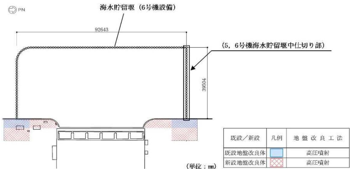
図 2.2-2-4 海水貯留堰 (6号機設備) の平面図
