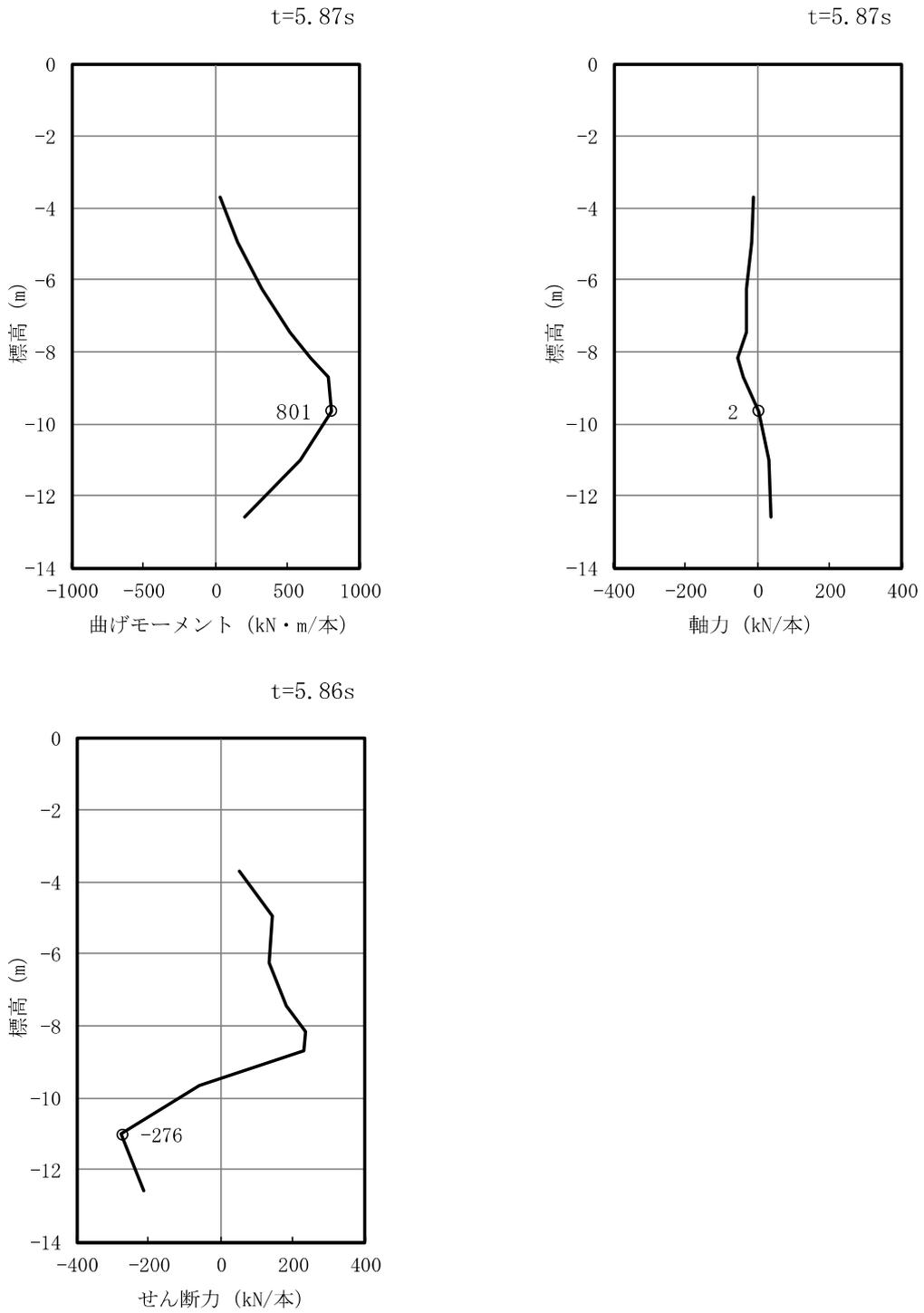
図 2.2-4-2 (2) 鋼管矢板において最も厳しい照査値の地震時断面力
