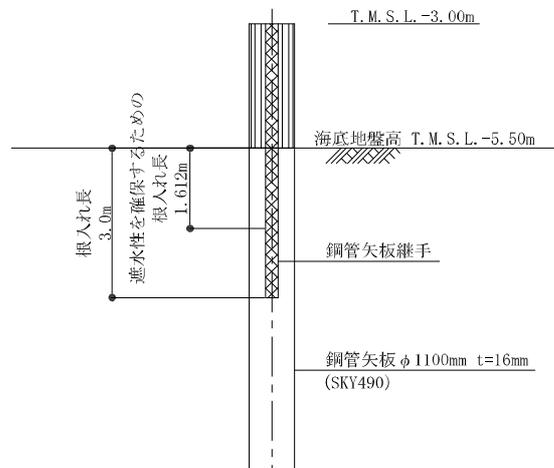
図 1 鋼管矢板継手の根入れ長の考え方
