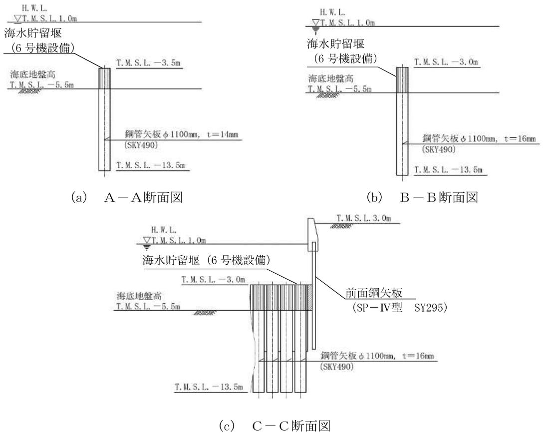
図 2.2-2-3 (1) 海水貯留堰 (6号機設備) の標準図
