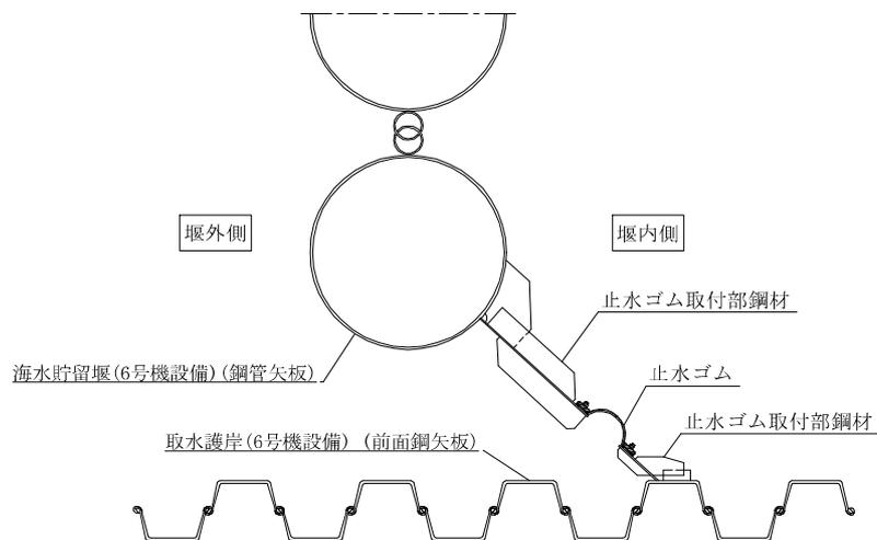
図2 止水ゴム詳細平面図 (6号機南側)
