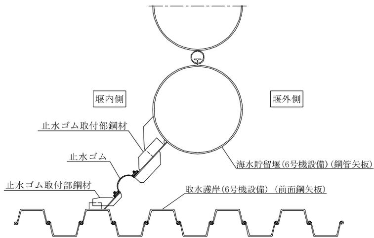
図3 止水ゴム詳細平面図 (6号機北側)
