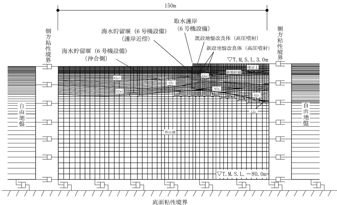
図 2.2-3-34 海水貯留堰の地震応答解析モデル (A-A断面)
