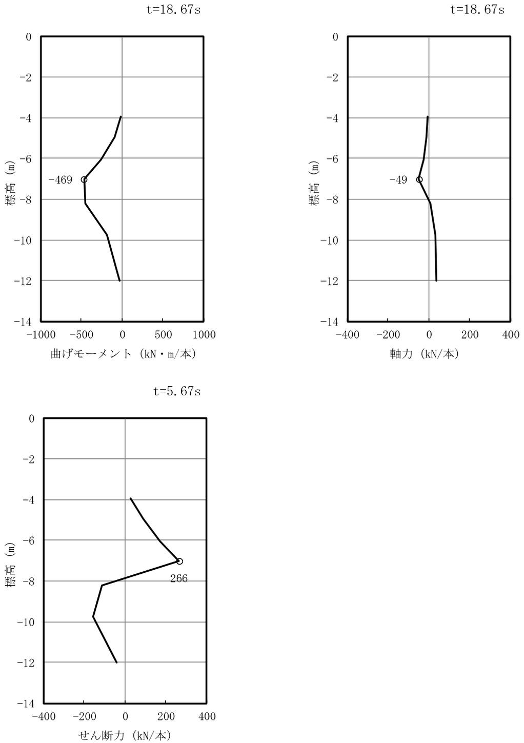
図 2.2-4-2 (1) 鋼管矢板において最も厳しい照査値の地震時断面力
