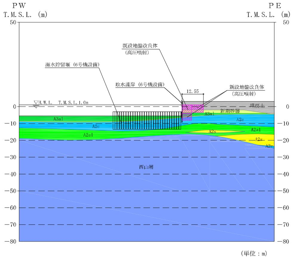
図 2.2-3-2 (1) 海水貯留堰 (6号機設備) の評価対象断面図 (A-A断面)
