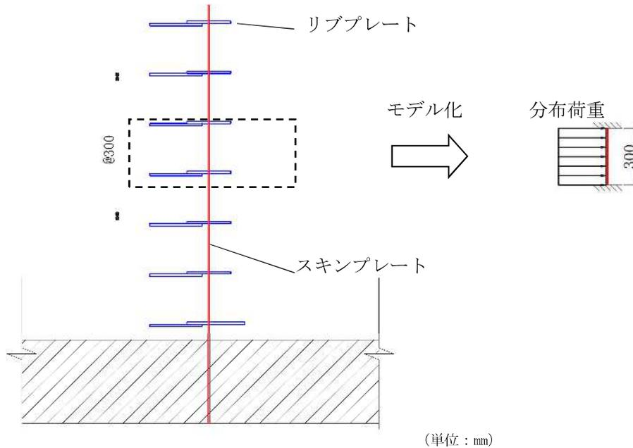
図 2.2-3-27 スキンプレート照査モデル図
