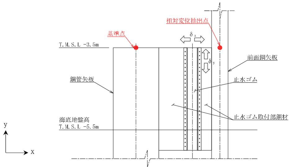
図 2.2-3-36 変位方向の定義 ( $\delta_x$ ,  $\delta_y$  断面図)
