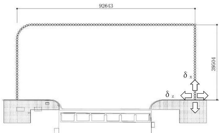
図 2.2-3-35 変位方向の定義 ( $\delta_x$ ,  $\delta_z$  平面図)
