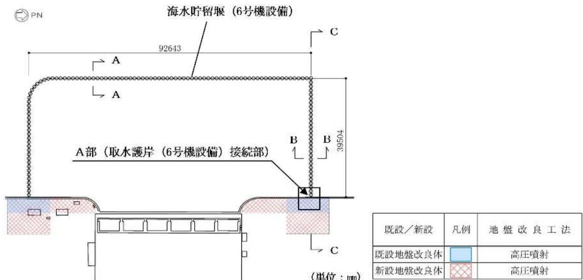
図2.2-2-2 (1) 海水貯留堰（6号機設備）の平面図
