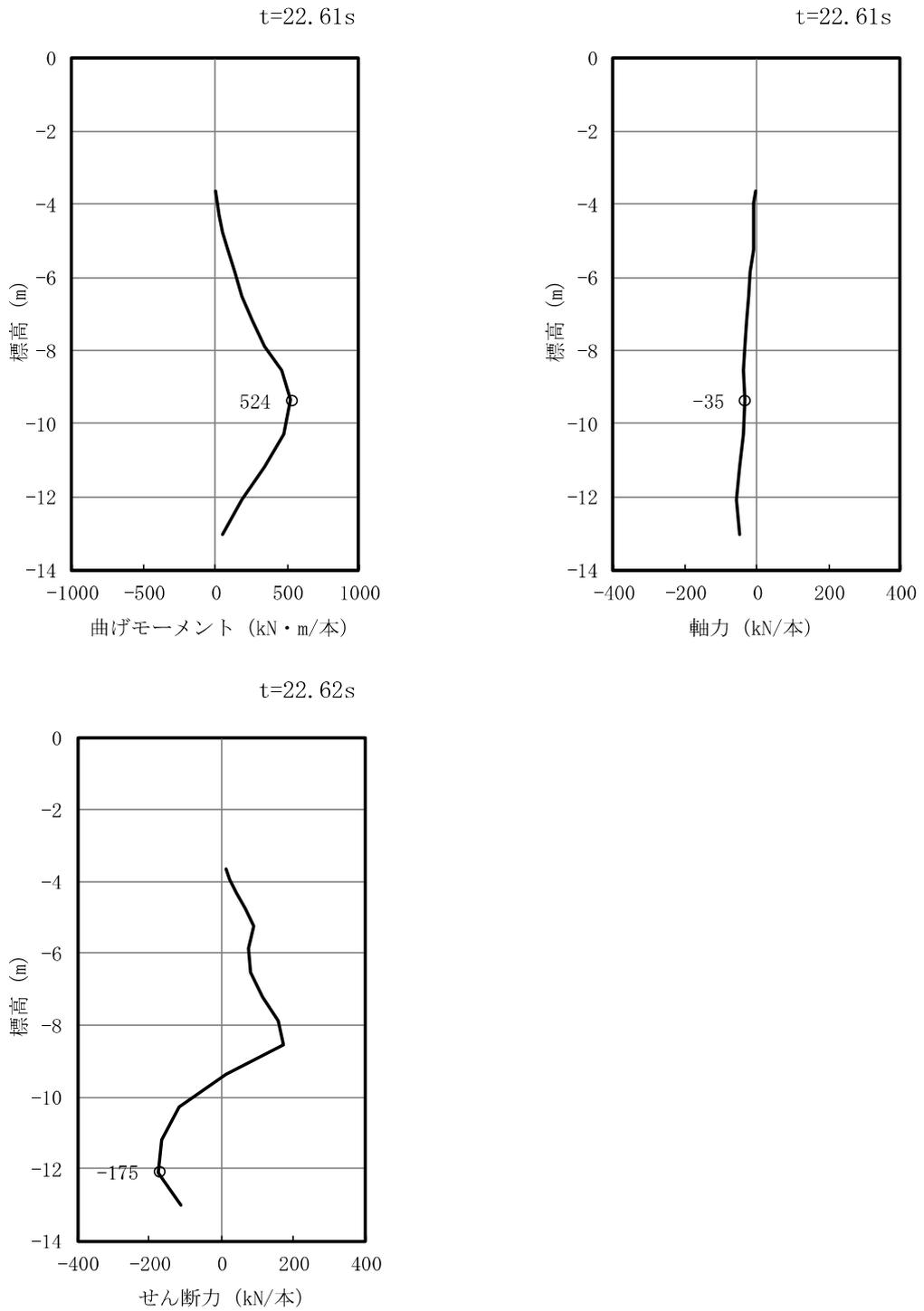
図 2.2-4-1 鋼管矢板において最も厳しい照査値の地震時断面力
