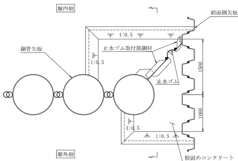
図1 根固めコンクリートの形状（平面図）
