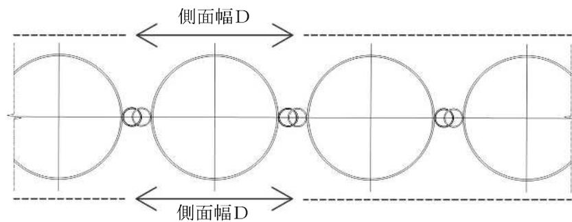
図 2.2-3-22 仮想ケーソン基礎の側面幅  $U_G$
