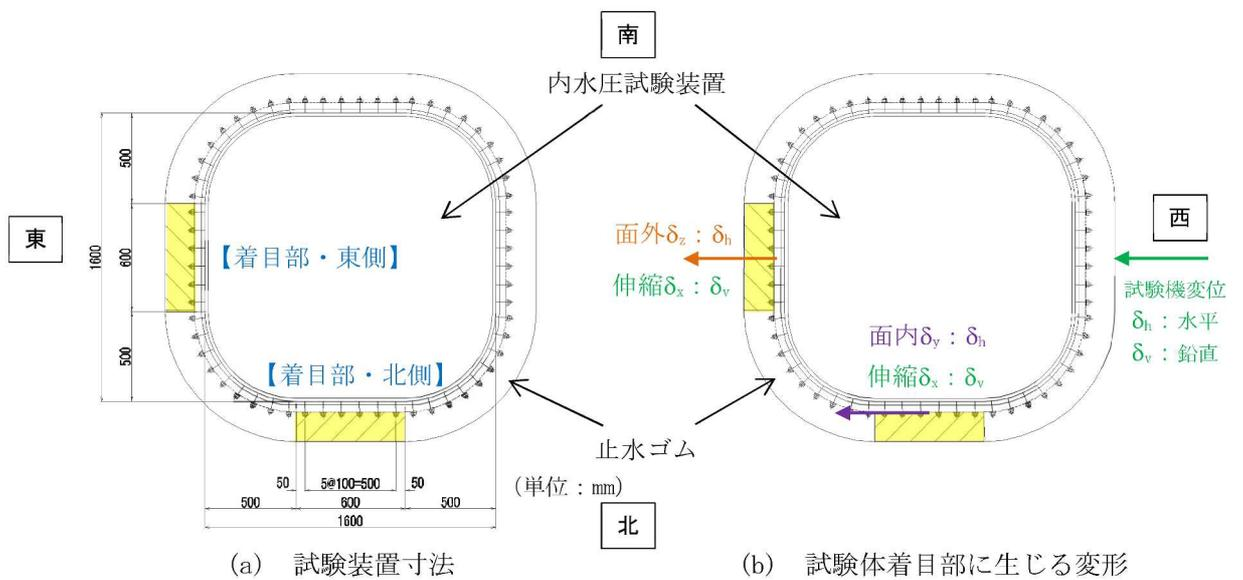
図8 変形概念図 (限界変形試験)
