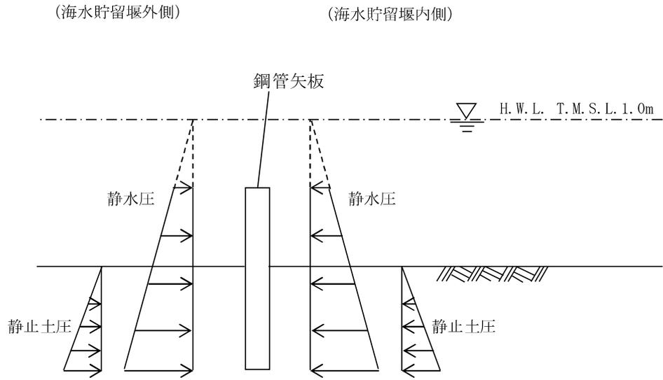
図 2. 2-3-6 荷重作用図 (鋼管矢板 常時)
