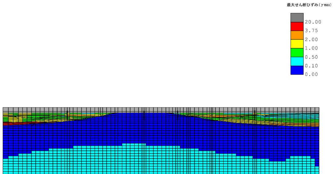
図 2.2-4-4 最大せん断ひずみ分布
