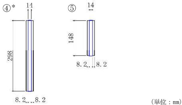
図 2.2-3-32 接合部の照査断面（照査断面寸法（溶接長）は腐食代を考慮）
