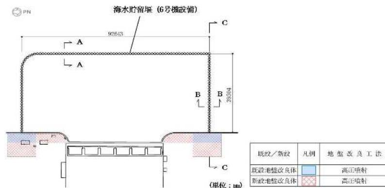
(a) 海水貯留堰（6号機設備）の平面図
