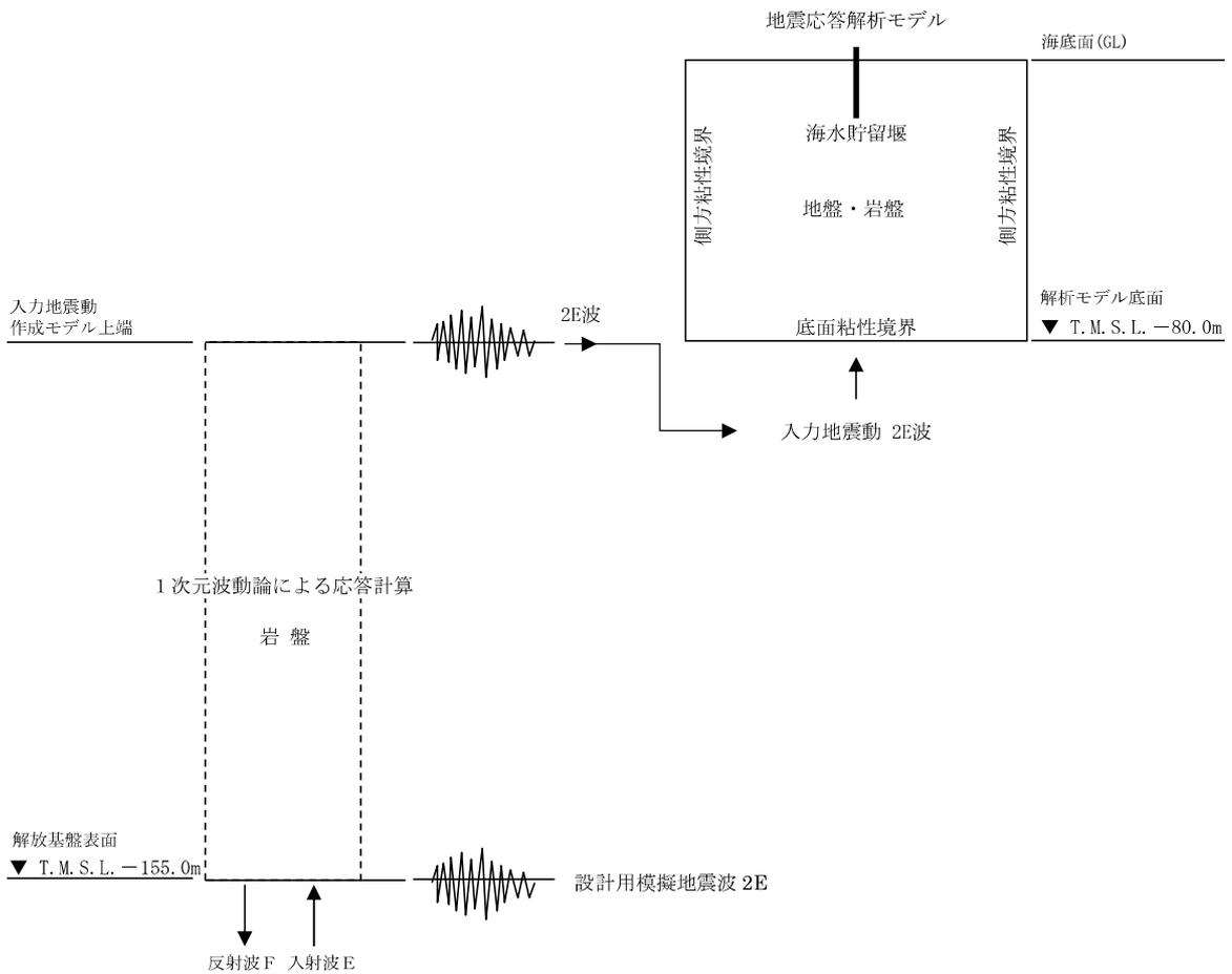
図 2.2-3-9 入力地震動算定の概念図
