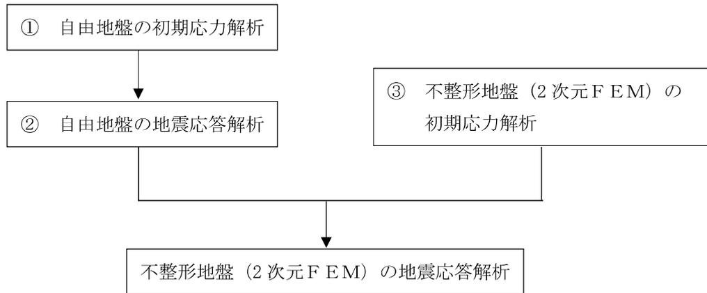
図 2.2-3-12 自由地盤の初期応力解析から不整形地盤（2次元FEM）の地震応答解析までのフロー
