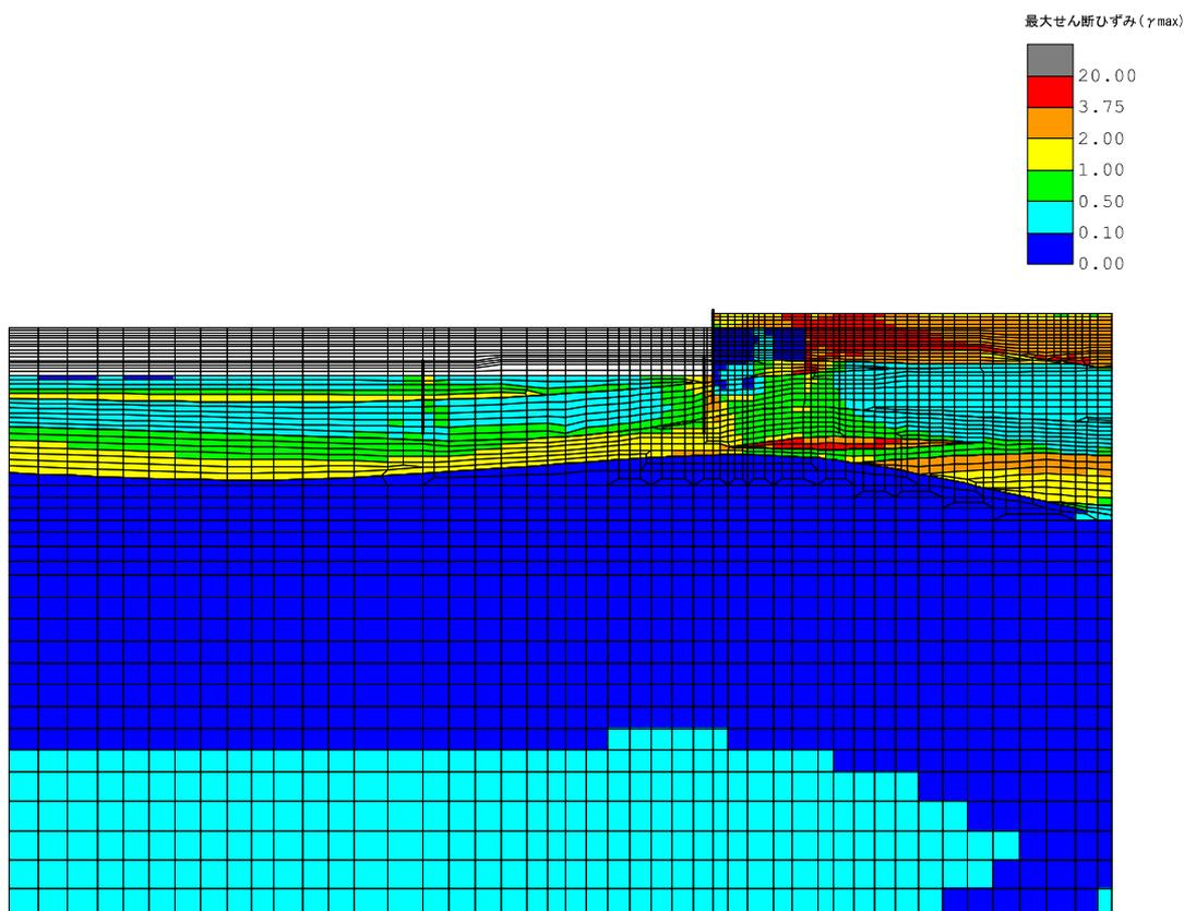
図 2.2-4-3 最大せん断ひずみ分布
