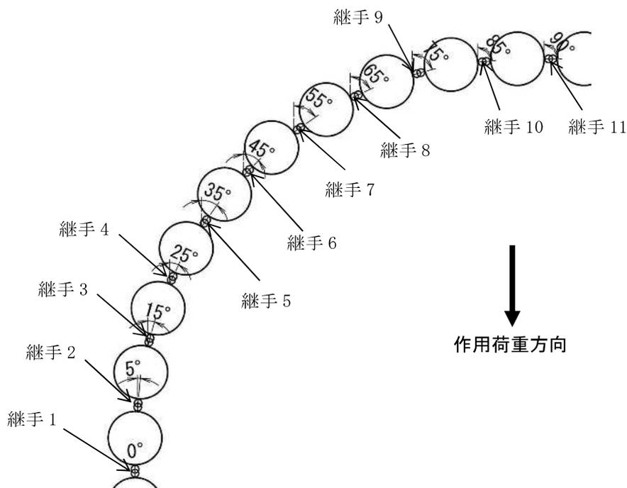
図 2 継手の取付角度 (隅角部)
