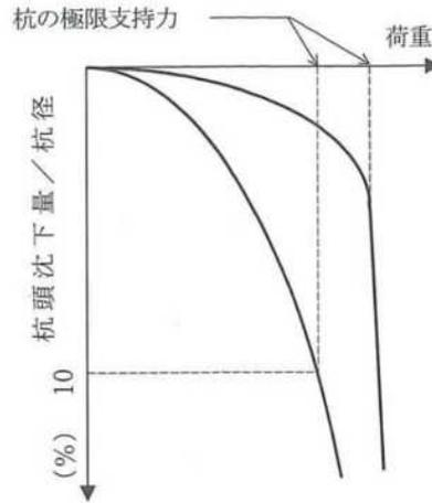
図 2.2-3-20 杭の鉛直載荷試験における一般的な荷重-変位関係
