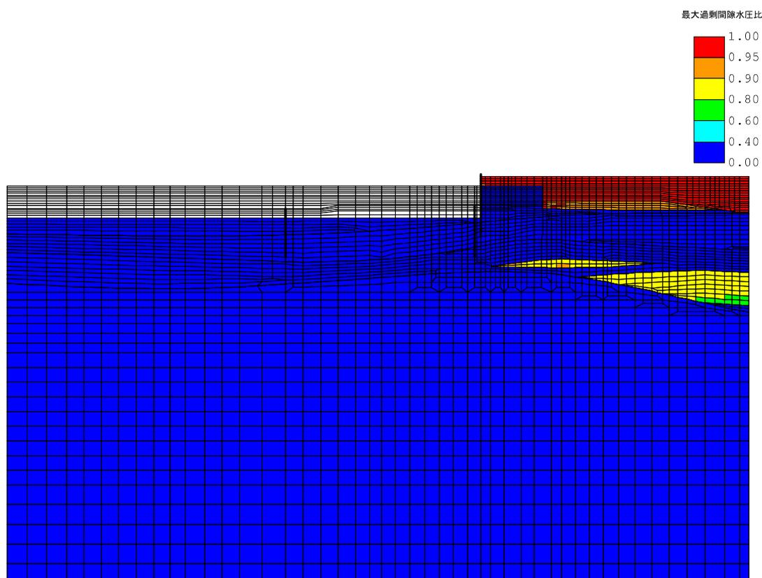
図 2.2-4-5 最大過剰間隙水圧比分布
