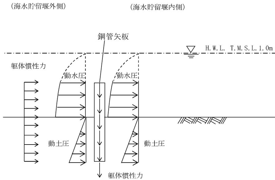
図 2. 2-3-7 荷重作用図 (鋼管矢板 地震時)
