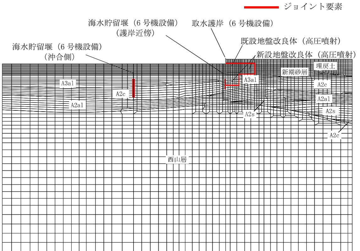
図 2.2-3-18 (1) ジョイント要素の配置 (A-A断面)
