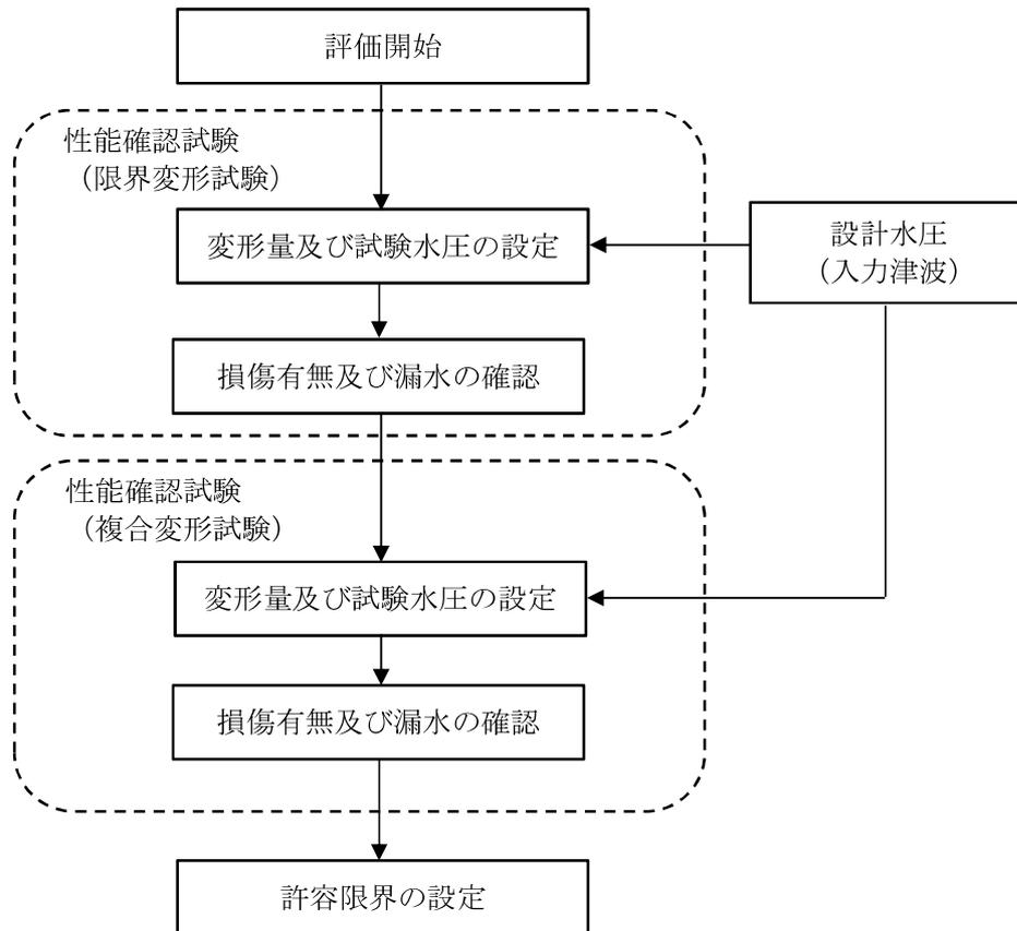
図5 性能確認評価フロー
