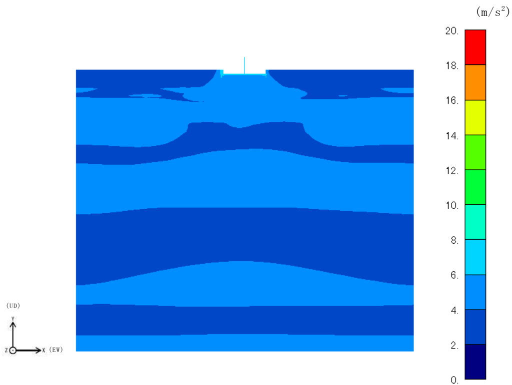
図 3-5 地盤の最大応答加速度 (Ss-3, EW 方向)
