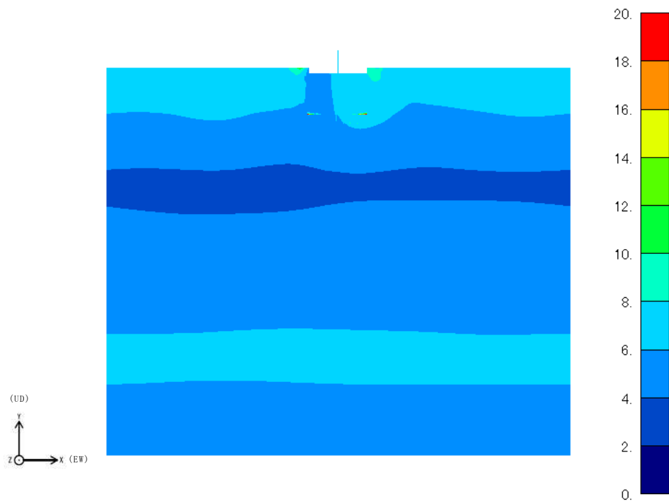
図 3-3 地盤の最大応答加速度 (Ss-1, 鉛直方向)
