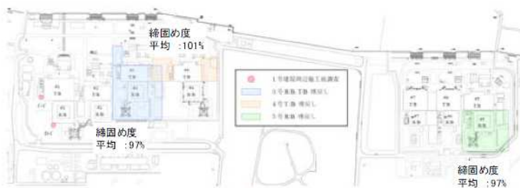
埋戻土の締固め度（建屋周辺）
