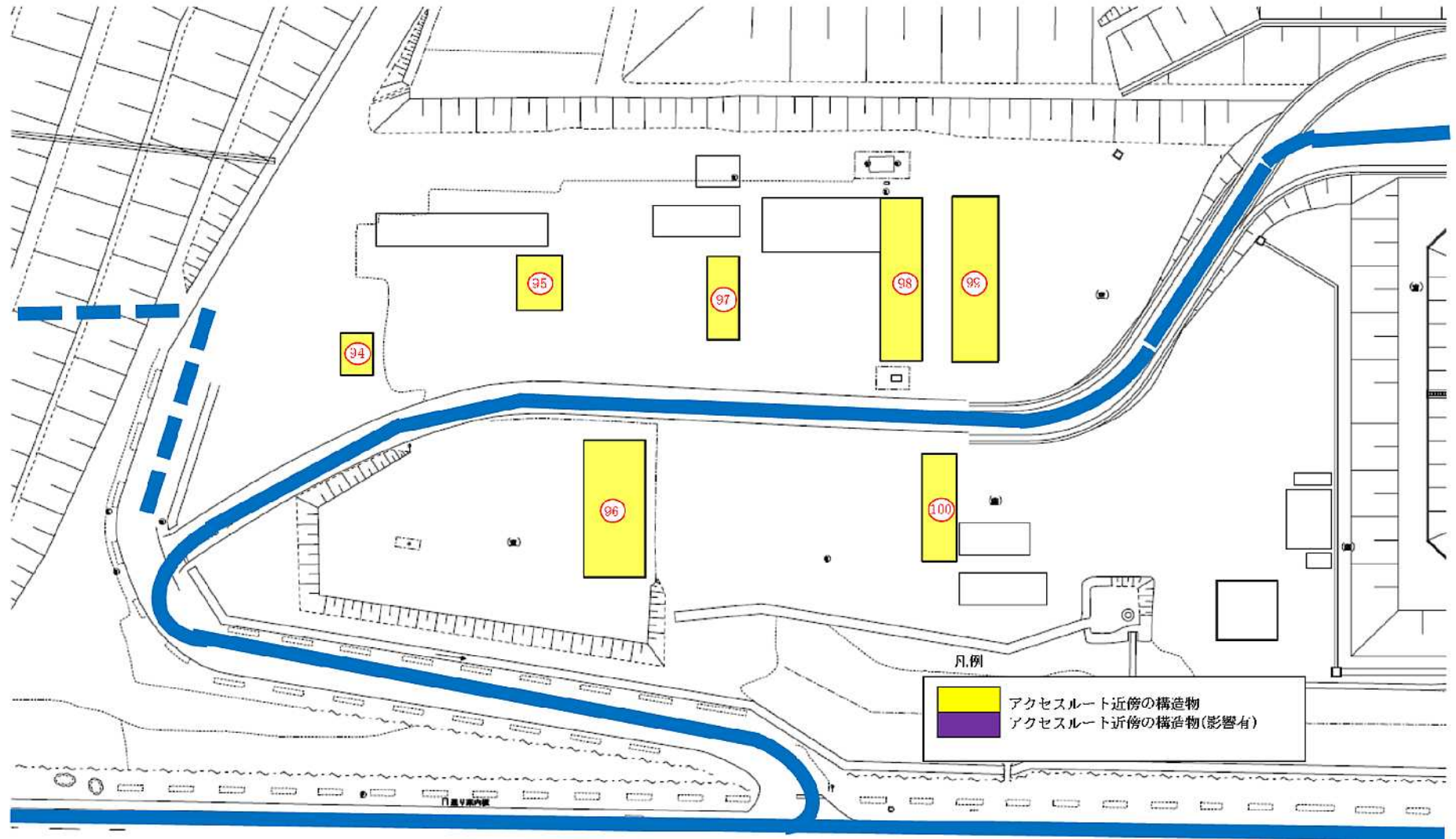
図 7-19 建屋倒壊時の屋外アクセラレートへの影響評価結果（企業棟詳細図）
