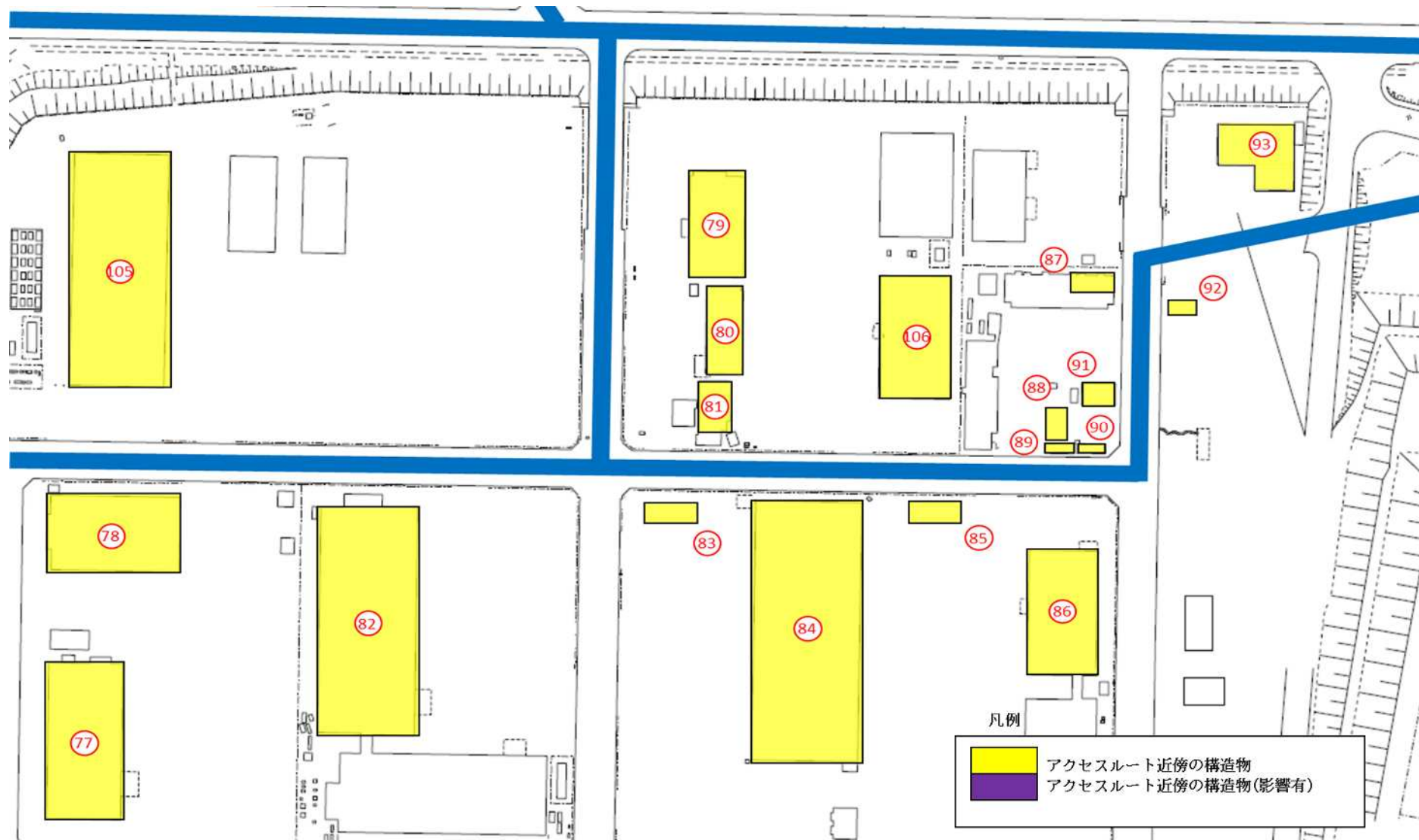
図 7-18 建屋倒壊時の屋外アクセラレートへの影響評価結果（企業棟詳細図）
