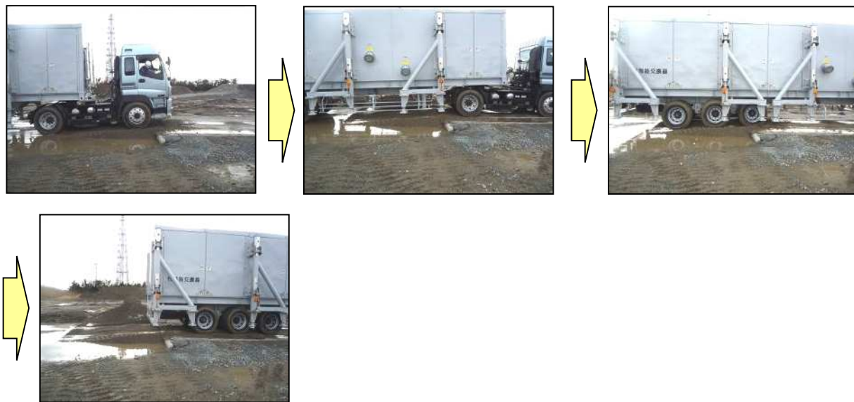
図 12-9 検証状況（約 20cm の段差）
