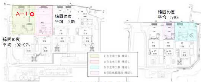
埋戻土の締固め度（海側）
