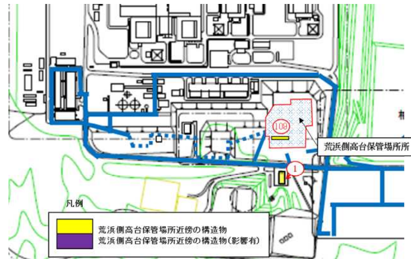
図 7-11 建屋倒壊時の保管場所への影響評価結果（荒浜側高台保管場所）
