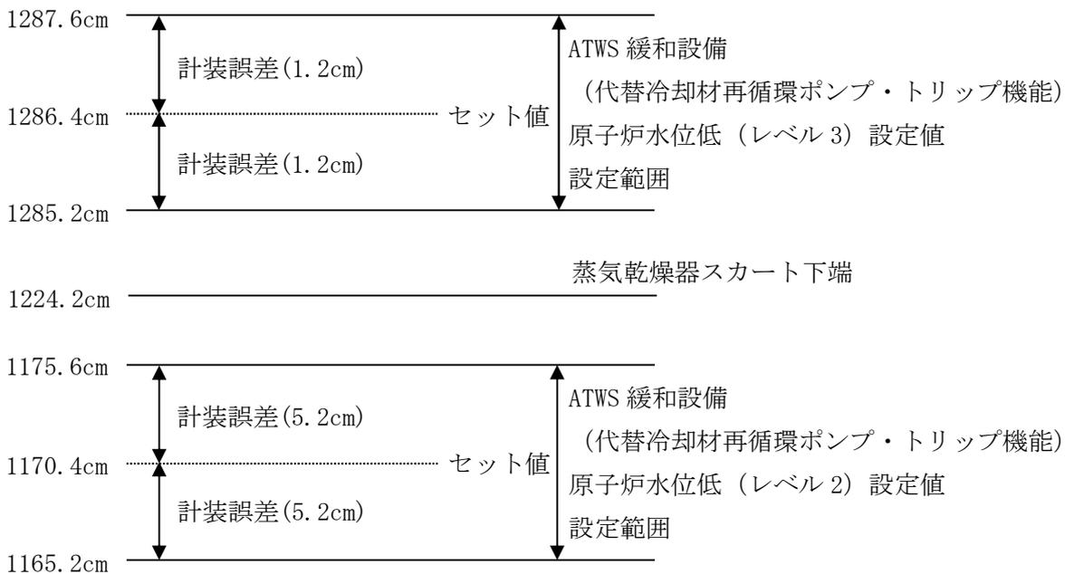
図 4-5 原子炉水位低（レベル 2）設定値の概要図
