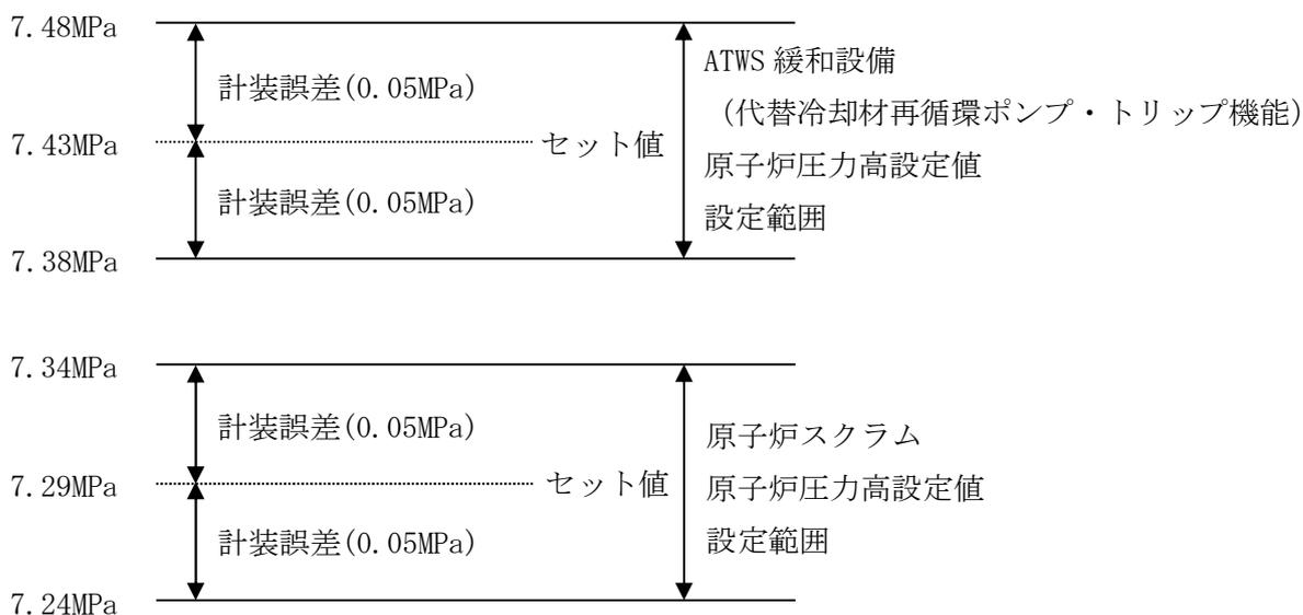
図 4-3 原子炉圧力高設定値の概要図
