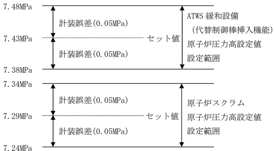
図 4-1 原子炉圧力高設定値の概要図
