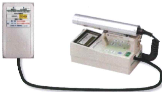
図6.2.43 現在運用している走行モニタリングシステム (NaI(Tl)シンチレーション式サーベイメータ + データロガー)
