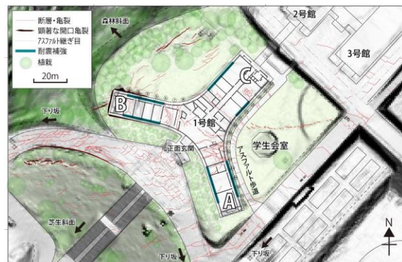
図2 東海大学阿蘇校舎1号館周辺および1号館1階床面の亀裂詳細図
