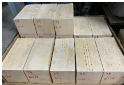
図 1.2.2.3-3 (a)模擬岩石供試体の作成に使用した養生型枠，(b)作成した模擬岩石供試体．
