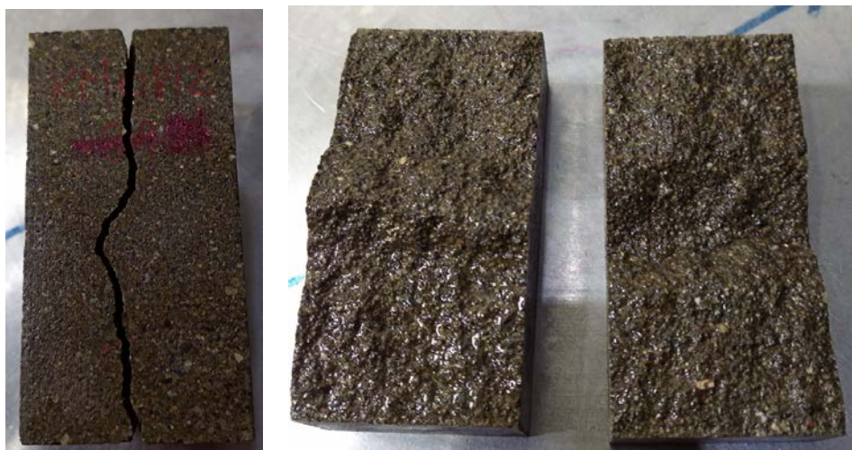
図 1.2.2.2-12 ケース 3：凹凸の面を持つ岩石（実験前）。
