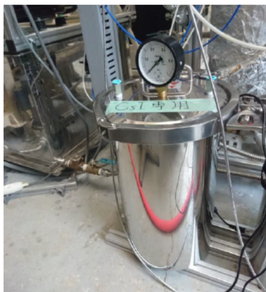
図 2.2 本年度に設備したバッファタンクの外観
