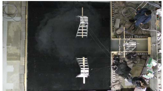
写真 4-10 アクリル板を 1 枚設置した場合のシルト投入後から 130-220 秒後までの拡散の様子
