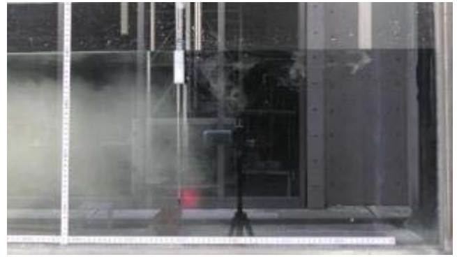
写真 4-1 ケース 1 (実験 No.1)(表 4-2)の条件で還流を発生させた際の x=2.5\text{ m} の位置の実験開始からの 0,5,10,20 秒後のシルトの拡散の様子。
