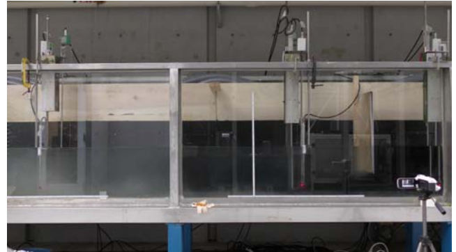
写真 4-3 ケース 2 (実験 No.1) (表 4-2) の条件でアクリル板を 1 枚入れた場合に還流を発生させた際のアクリル板付近の様子。実験開始から 40~55 秒後のシルトの拡散の様子。
