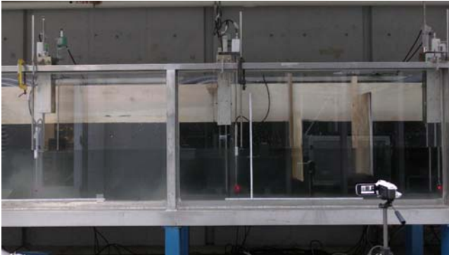
写真 4-5 ケース 3 (実験 No.1) (表 4-2) の条件でアクリル板を 2 枚入れた場合の還流を発生させた際のアクリル板付近の実験開始から 40~55 秒後のシルトの拡散の様子。
