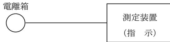
図3-25 電離箱サーベイメータの概略構成図
