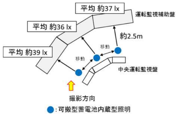
図 1-3 中央制御室シミュレーション施設における可搬型蓄電池内蔵型照明確認状況
