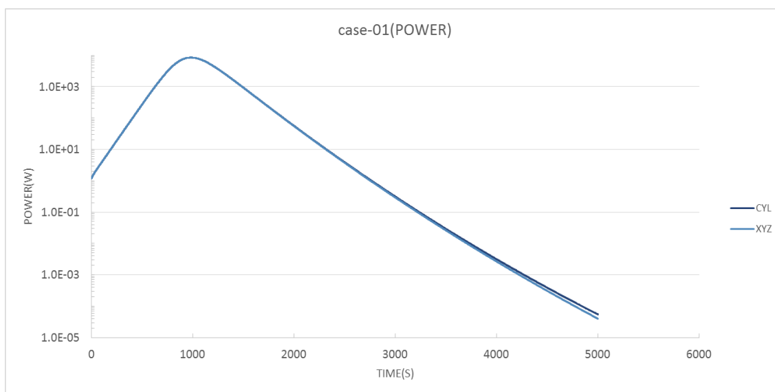
図 9.5-6 AGNES-P による case-01 臨界事故解析 出力時間変化 (CYL : 2次元円筒形状モデル、XYZ : 3次元平板形状モデル)
