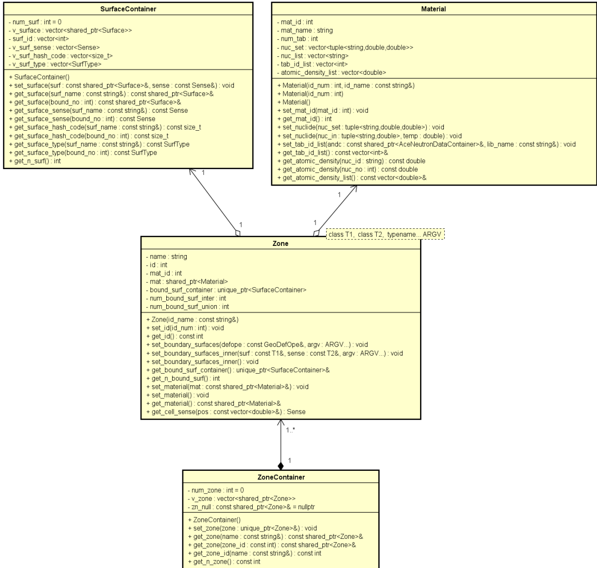
図 4.2-2 拡張した Zone クラスとそれぞれのコンテナおよび物質クラスとの関係図
