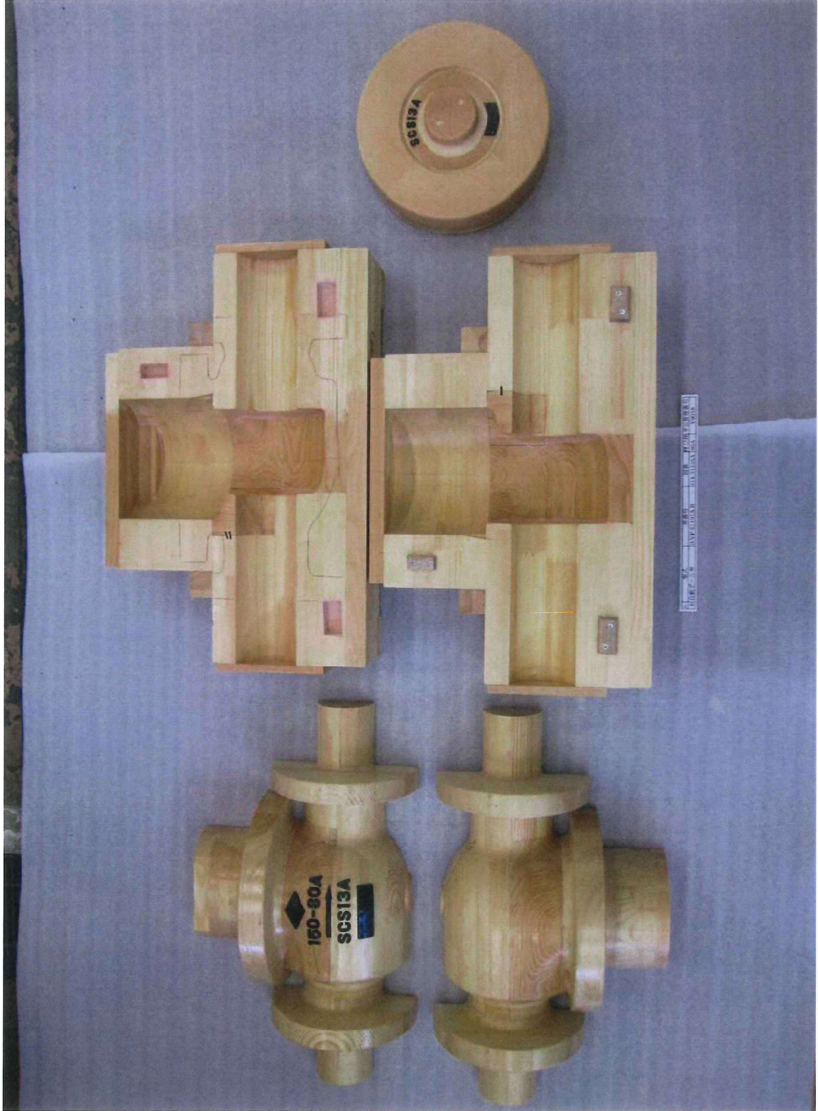
図6. 2. 2-1 (2) 給排水系主要弁 (急速排水弁) の木型
