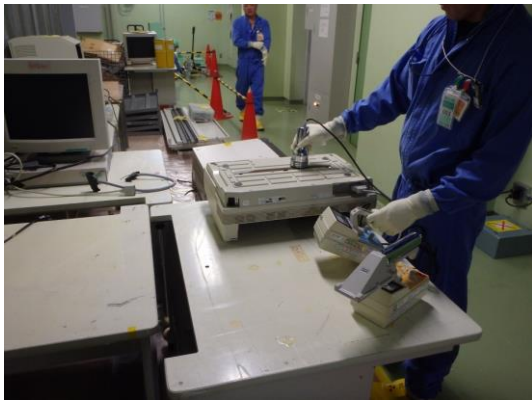
図 6.5-13 不用品及び撤去物の汚染検査
