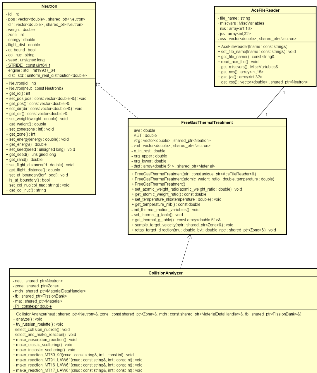
図 4.2-5 自由気体熱的処方に関連したクラス間の関係を示すクラス図
