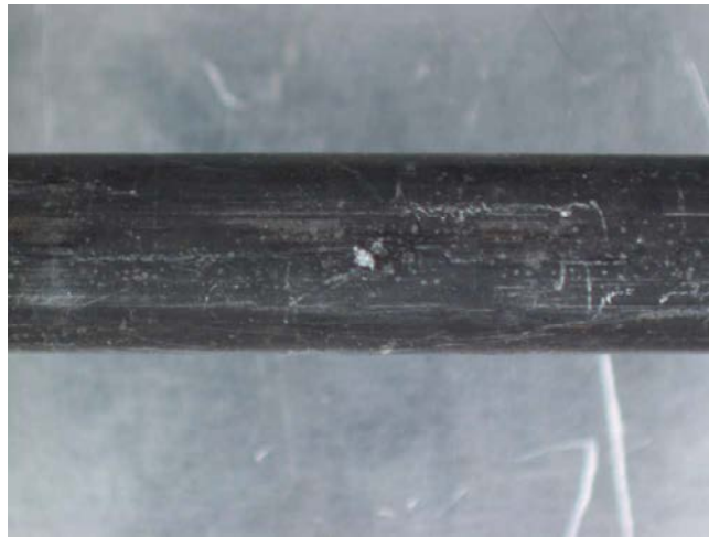
図 4.3.2-2 OS-1 試験燃料棒の約 160 mm に対応する外径ピーク位置の パルス照射前外観写真
