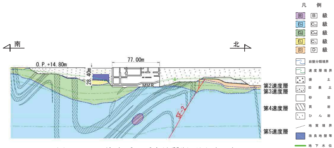
図 4.6-9 海水ポンプ室地質断面図 (A-A)
