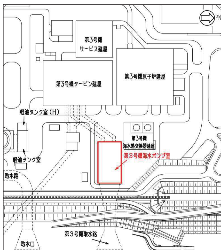
図4.12-1 第3号機海水ポンプ室配置図
