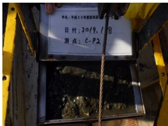
海底土の状況(C-P2)
