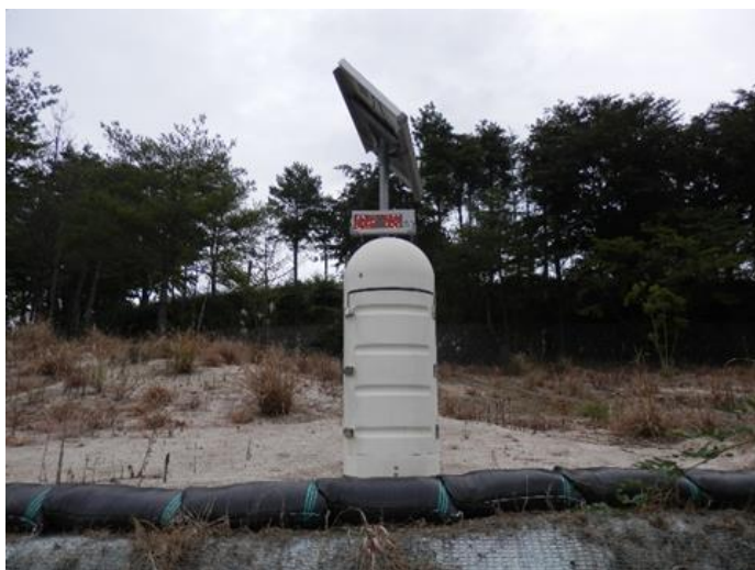
図 8 リアルタイム線量測定システム
