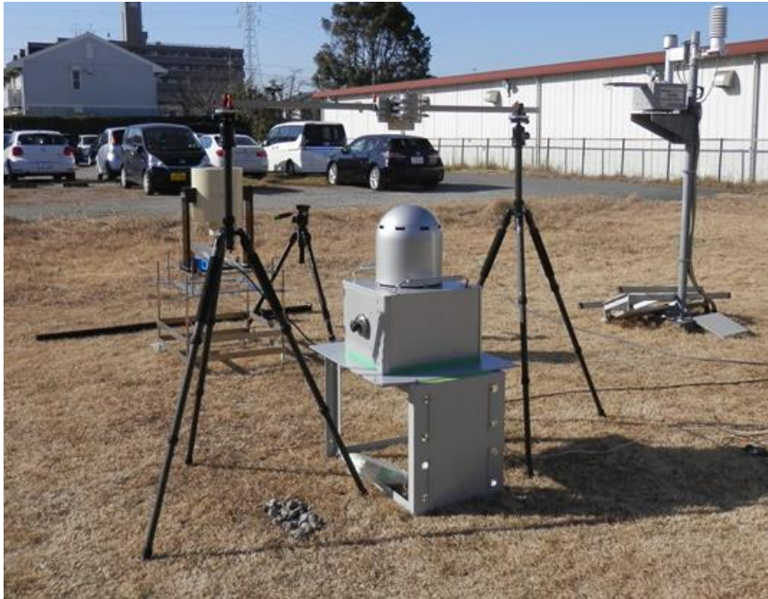
図 2 2 本研究で開発した照射装置による校正風景
