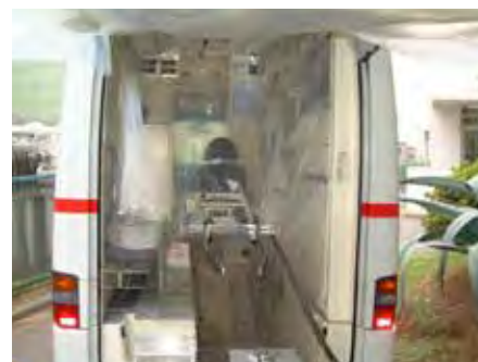
図3 車両内部の養生
