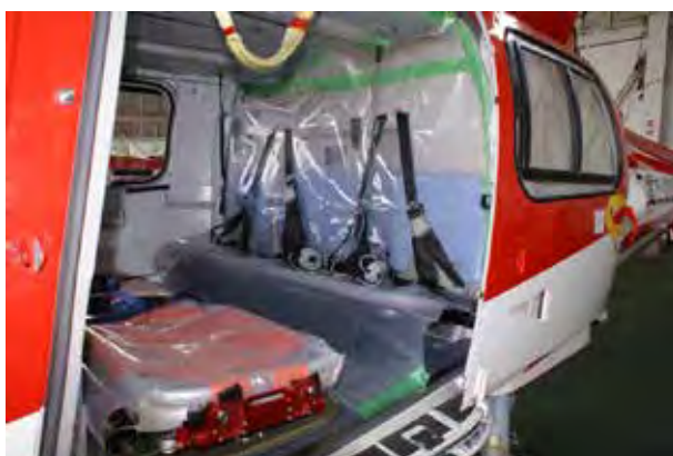
図9 養生シートの貼付 辺縁はテープでしっかりと貼り付ける。 ベルトなどはビニールに切り込みを入れて出す。ベルト自体は、傘用のビニール袋などを利用すると養生が容易である。
