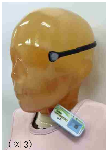
図 3. 左眼付近（水晶体近傍）に装着した水晶体線量計（DOSIRIS）。
