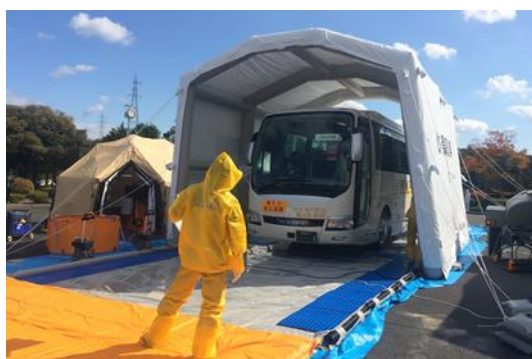
除染テントを用いた流水除染
